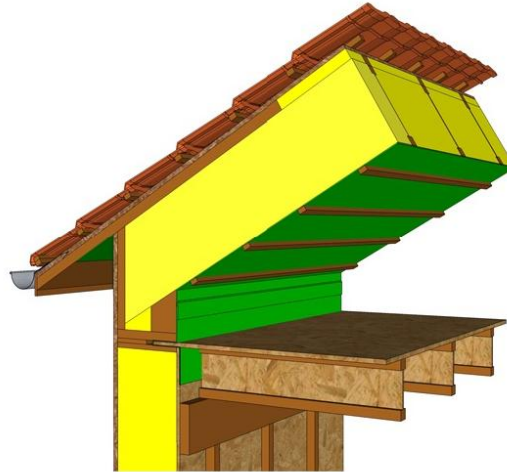
Fig 34 Sporendakpakket: zicht op de geplaatste isolatie, dampremmende laag en leidingsponw-latten. [80]
