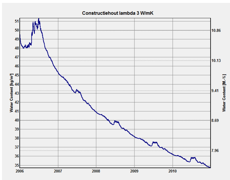
Fig 57 Vochtgehalte in de materiaallaag met aangepaste \lambda -waarde, t.p.v. de bouwknop, in functie van de tijd (WUFI)
