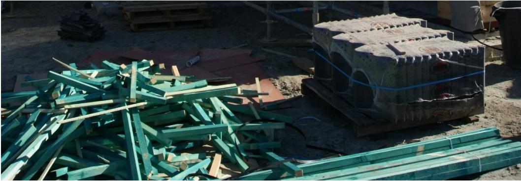
Fig 15 Verduurzaamd hout wordt gekenmerkt door een groene kleur
