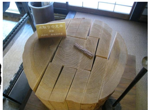
Fig 11 Karakteristieke vervorming van vierkante, rechthoekige en ronde dwarsdoorsneden na het drogen. De vervorming wordt beïnvloed door de richting van de jaarringen in het stuk hout. Tangentiale vervorming is het grootst [58]. Foto van de differentiële vervormingen na droging (Prof. Dr. Ir. Arch. Firmin Mees)
