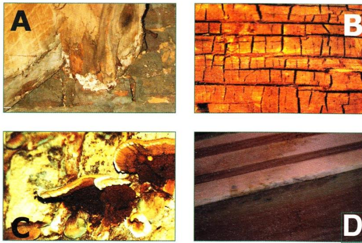
Fig 38 Schimmelaantasting door A: Witrotschimmel, B: Bruinrotschimmel, C: Huiszwam, D: Blauw-schimmel
