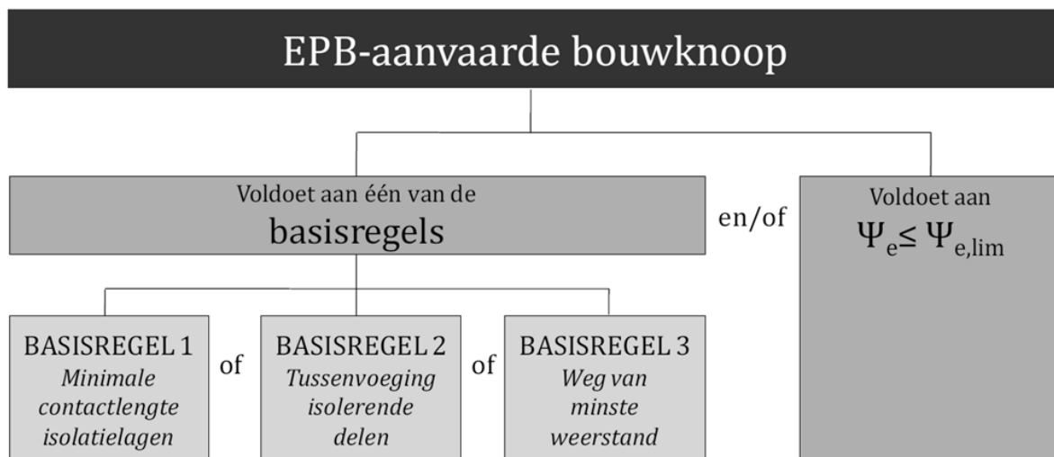
Fig 428 Principeschema voor een EPB-aanvaarde bouwknop. [67]
