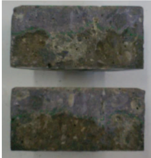
Figuur 19: Gespleten proefstuk voor het bepalen van de chloride-indringing
