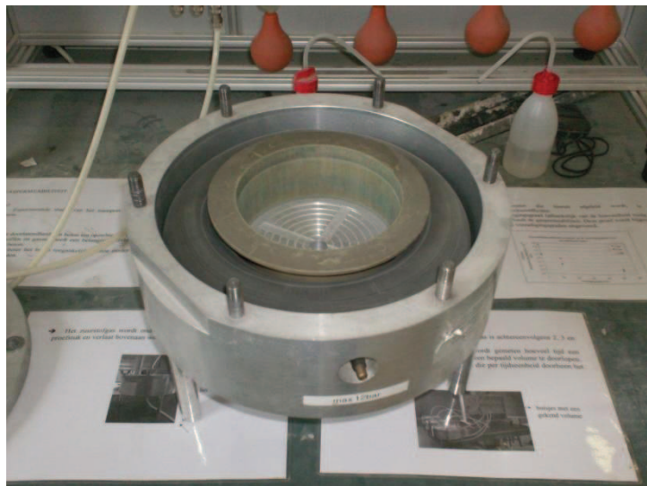
Figuur 12: Binnenkant van de luchtdichte houder met plaats voor het proefstuk
