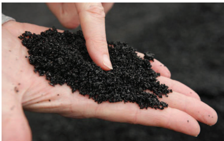
Figuur 1: Metamix: gegranuleerde, amorfe koperslak (bron: www.metallo.com )
