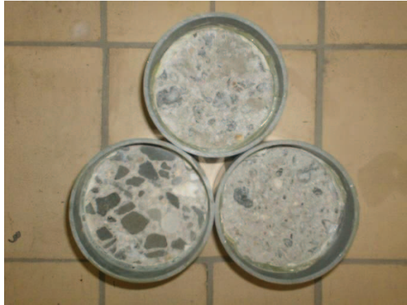
Figuur 16: Drie soorten proefstukken na doorlopen van 28 vorst-dooicycli; boven=A, links=B en rechts=C
