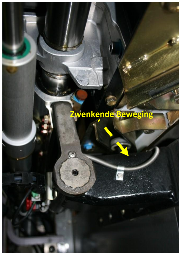
Figuur 113: Bovenste geleidingsrail met rollen zorgt voor zwenkende beweging dubbele instapdeur HV M6
