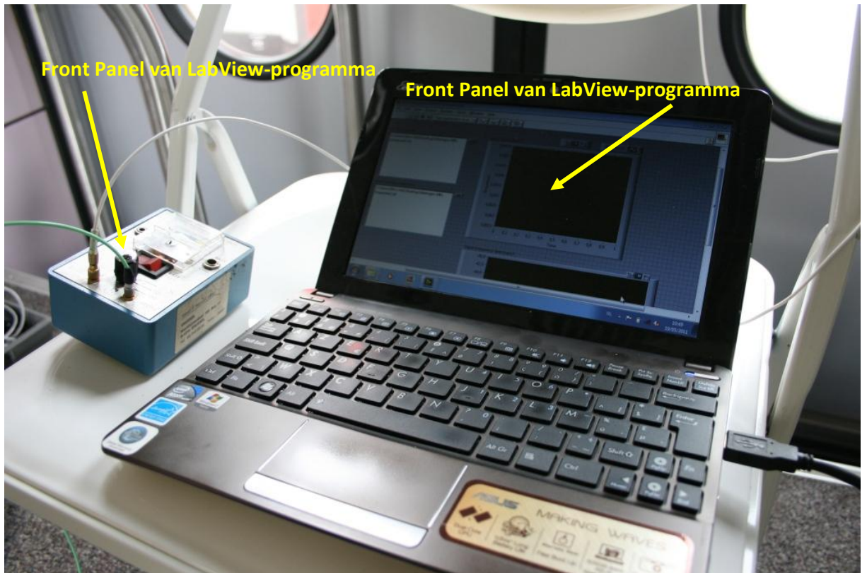
Figuur 117: Signaalconditionering / Voeding accelerometer + Nettop met LabView-programma om data van de DAQ te capteren
