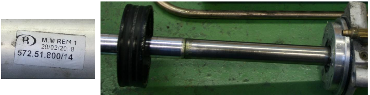
Figuur 132: Vastgelopen deurgilinder AM86-89
