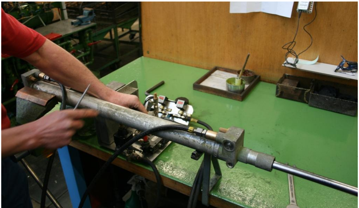
Figuur 89: regelen demping op in- en uitgaande slag tijdens revisie deurbcilinder te CW Mechelen
