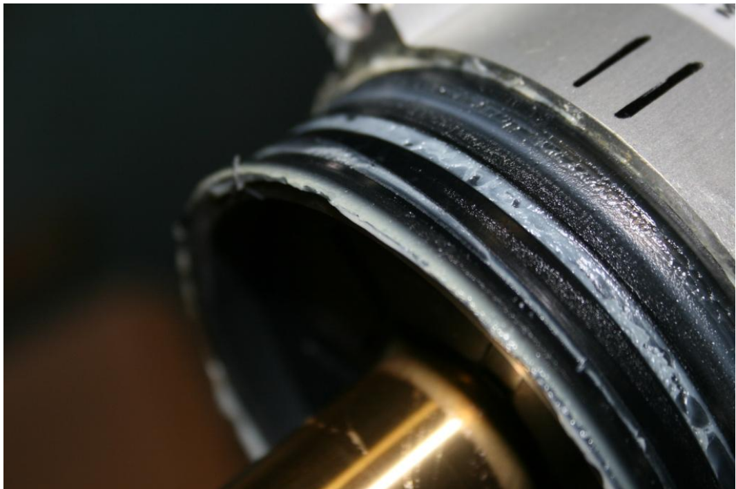
Figuur 131: Afzetting van witachtig vet op dichting deurglijcilinder AM96/I11 bij onderzoek te Labo Soete
