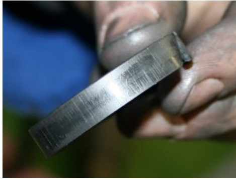
Figuur 95: Sporen van slijtage aan geleiding
