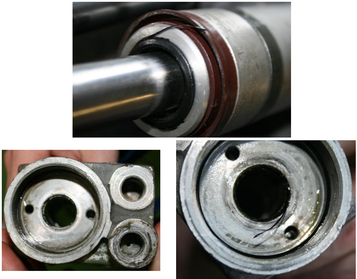
Figuur 90: Afbreken rubberpartikels stuit (oud model)
