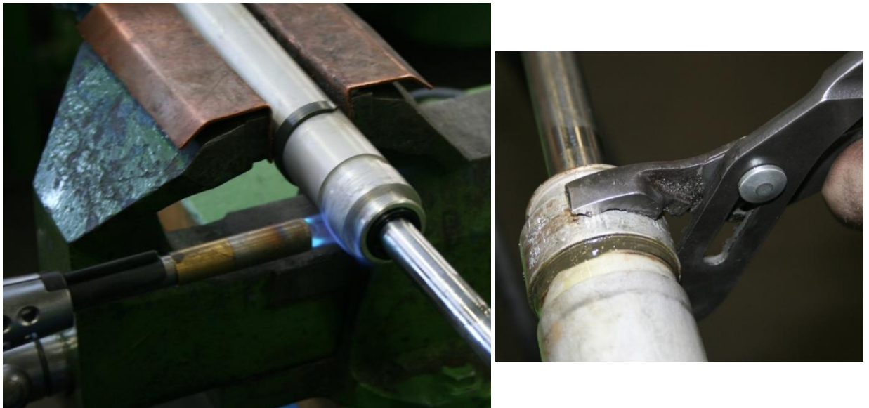
Figuur 99: Breken van de schroefdraadborging bij eerste trap ('oud' model)
