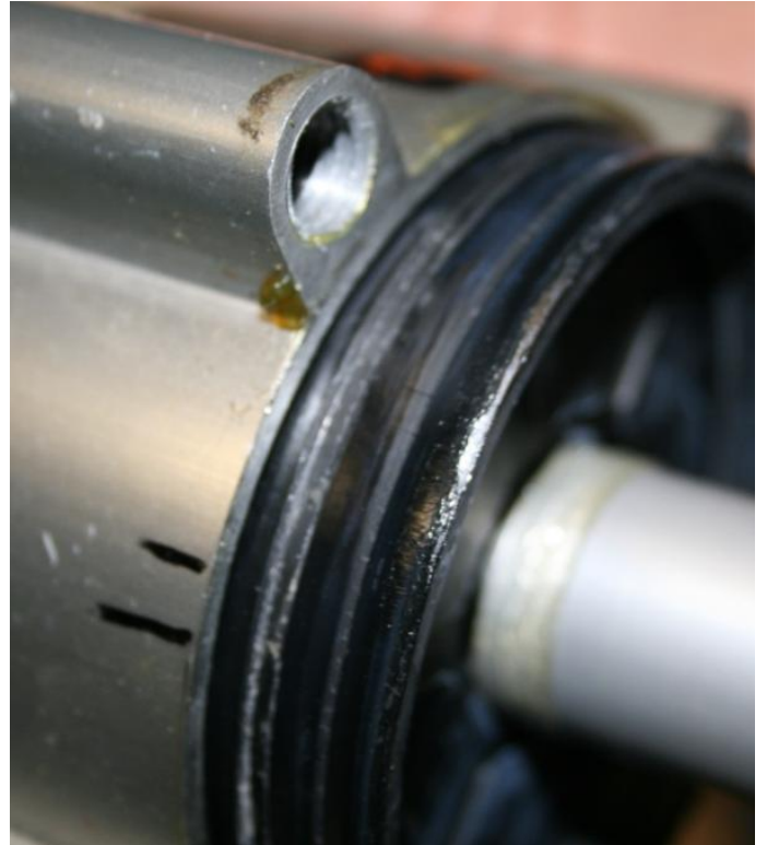
Figuur 130: Sporen van adhesieve slijtage op de cilindermantel en fluogroen vet op de demping (links) – Weinig tot geen vetafzetting op de dichting (rechts) van de deurglijcilinder AM96/I11 bij onderzoek te Labo Soete
