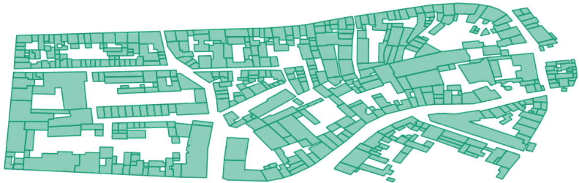
Figuur 5.3: Modelling van een klein gedeelte van Gent in een shapefile. Elke veelhoek stelt een gebouw voor.
