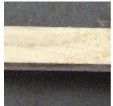
Figuur 48: Afwijking van vezelrichting
