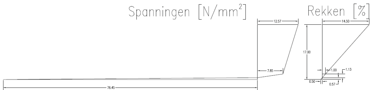
Figuur 50: Spanningen en rekken in proefstuk tijdens buigen
