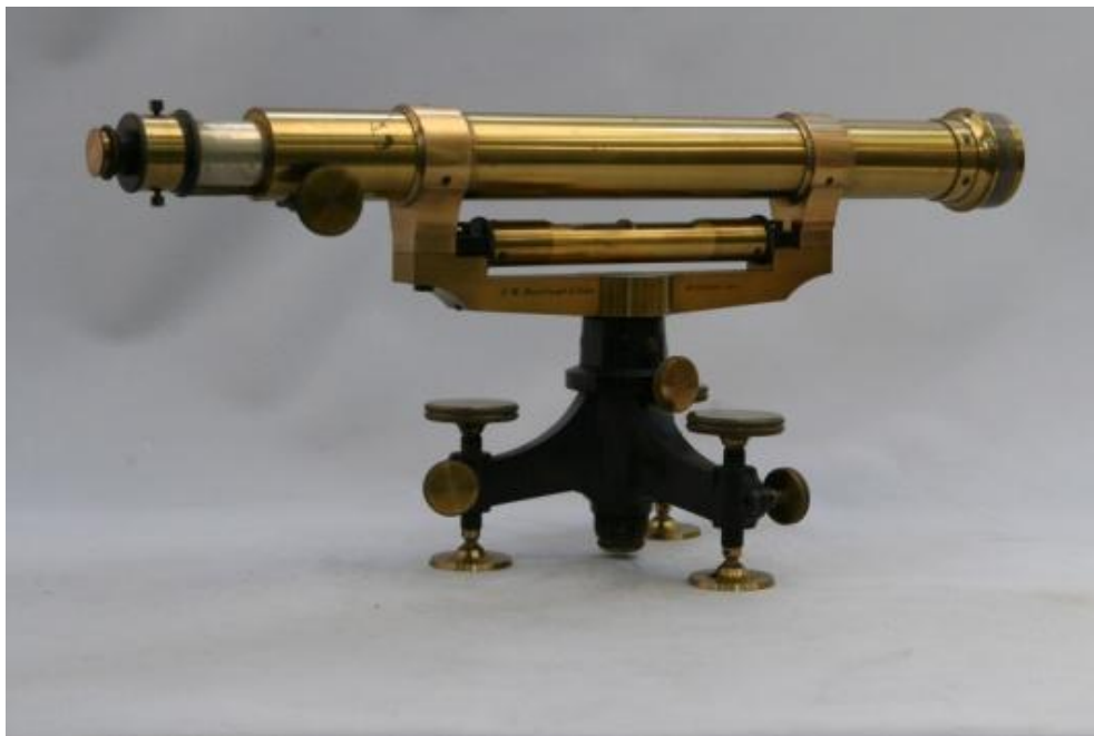
Figuur 43 : waterpasinstrument type alles vast Bron : museum voor de geschiedenis van de wetenschappen, 2007
