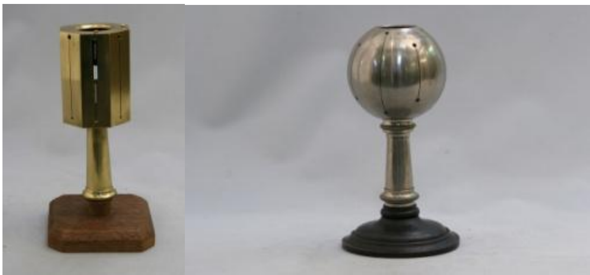
Figuur 65 & 66 : achthoekig & kogelvormig landmeterskruis Bron : museum voor de geschiedenis van de wetenschappen, 2007
