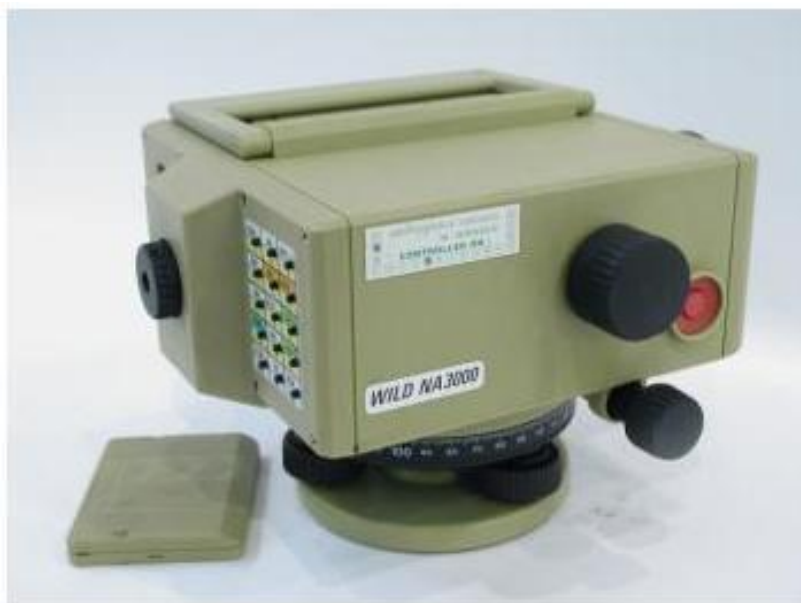
Figuur 54 : digitaal waterpasinstrument NA 3000 Bron : museum voor de geschiedenis van de wetenschappen, 2007
