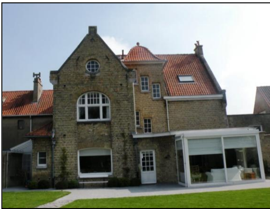
Foto 22: Achtergevel van "Ons Huis" met een "eerlijke" en rationele opbouw. De getrapte ramen in het torentje duiden op de aanwezigheid van het trappenhuis binnenin. Eigen fotomateriaal (18/04/2011).
