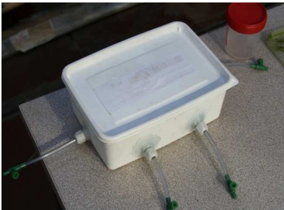
20/10/2009, EXP 1, De volumeregelaar van de perifyton-incubator, niet aangesloten.
