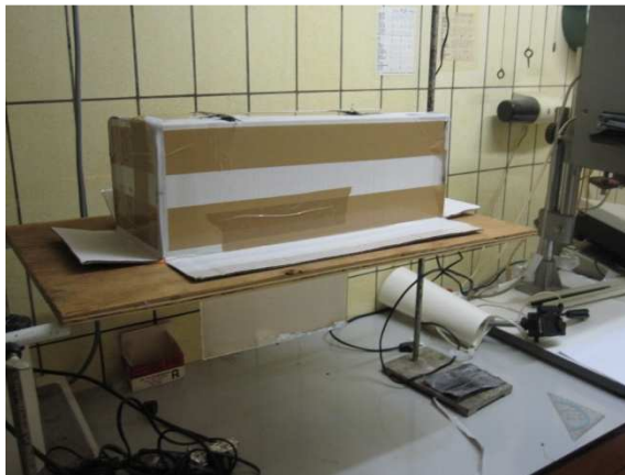
28/11/2009, De proefopstelling ter selectie van een ideale plaat voor lichtherverdeling.
