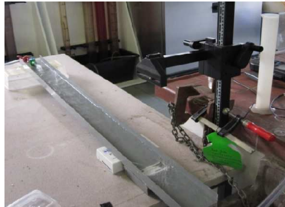
5/01/2010, EXP 2, De schuifspanningsreactor ter bepaling van de aanhechtingssterkte van het perifyton
