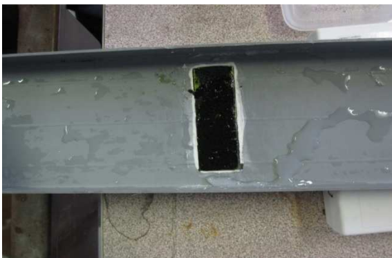
5/01/2010, EXP 2, Een objectglasje met perifyton ingesloten in de caviteit van de schuifspanningsreactor
