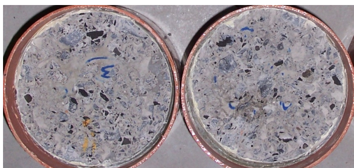
Figuur 5-3: Bekistingsvlak CRC 3b op 1 maand ouderdom na 28 vorst-dooicycli
