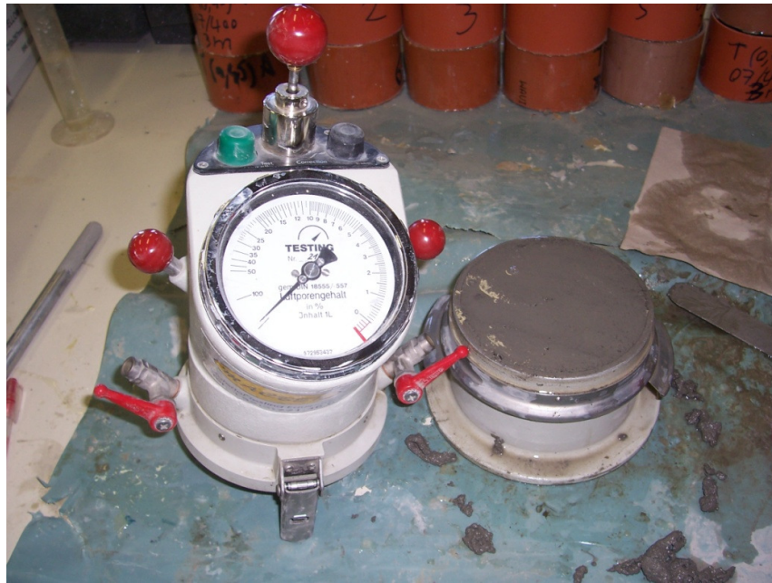
Figuur 3-27: Bepaling luchtgehalte [links: drukmeter; rechts: met mortel gevuld vat]
