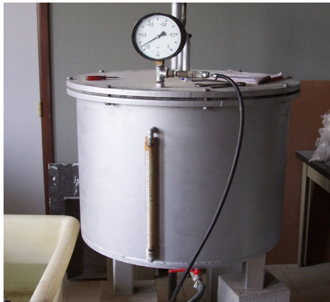
Figuur 3-21: Vacuümtank voor wateropsorping
