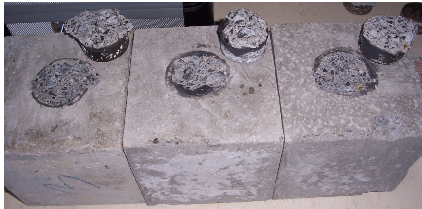
Figuur 4-6: Losgescheurde metalen cilinders op het beproefde bekistingsvlak
