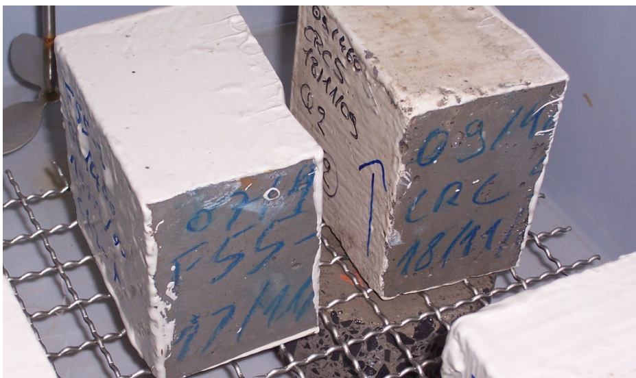
Figuur 3-13: Opstelling chloride-indringing kubussen
