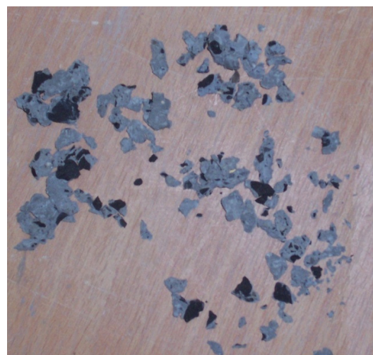
Figuur 4-19: Afgeschilderd materiaal bij recycleerbaar mengsel
