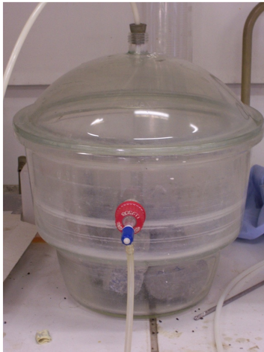
Figuur 3-14: Opstelling vacuümverzadiging
