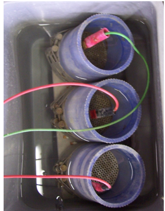
Figuur 3-15: Opstelling van de CTH-proef
