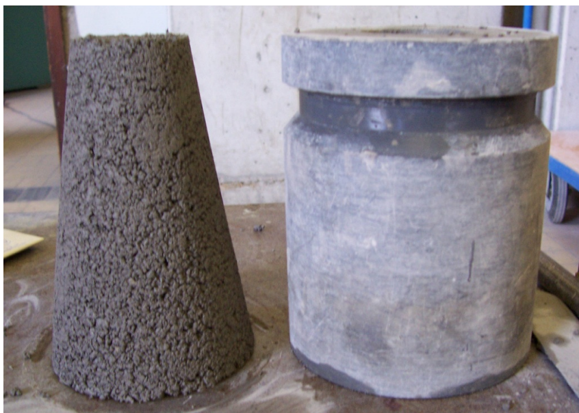
Figuur 4-36: Slump bij toevoeging van wijnsteenzuur ter grootte van 1,00m% van het geheel aan bindmiddelen
