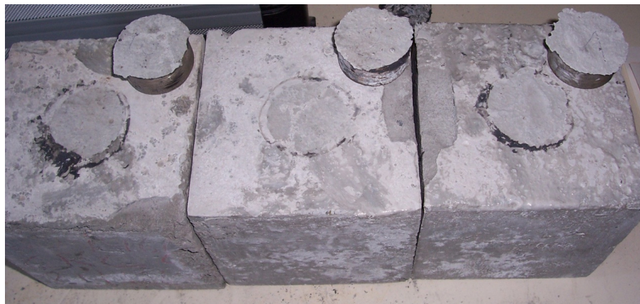
Figuur 4-5: Losgescheurde metalen cilinders op het beproefde afstrijkvlak
