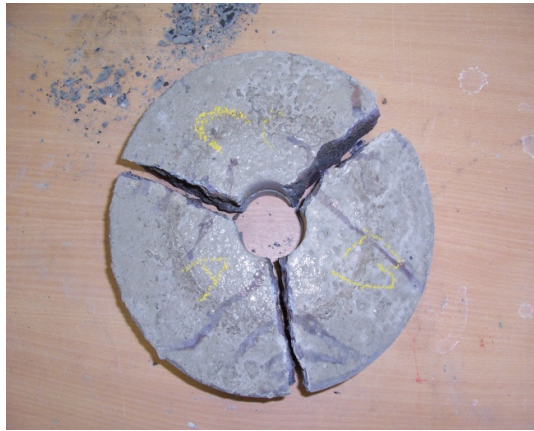
Figuur 3-11: Gebroken TAP-wiel
