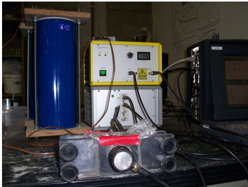
Figuur 3-26: Freshcon-opstelling voor ultrasone transmissie en semi-adiabatische calorimetrie [vooraan: monster in container voor ultrasoonmeting; links: geïsoleerd vat met monster voor temperatuursmeting; midden (van boven naar onder): temperatuurskaart, pulsgenerator, voorversterker; rechts: monitor]
