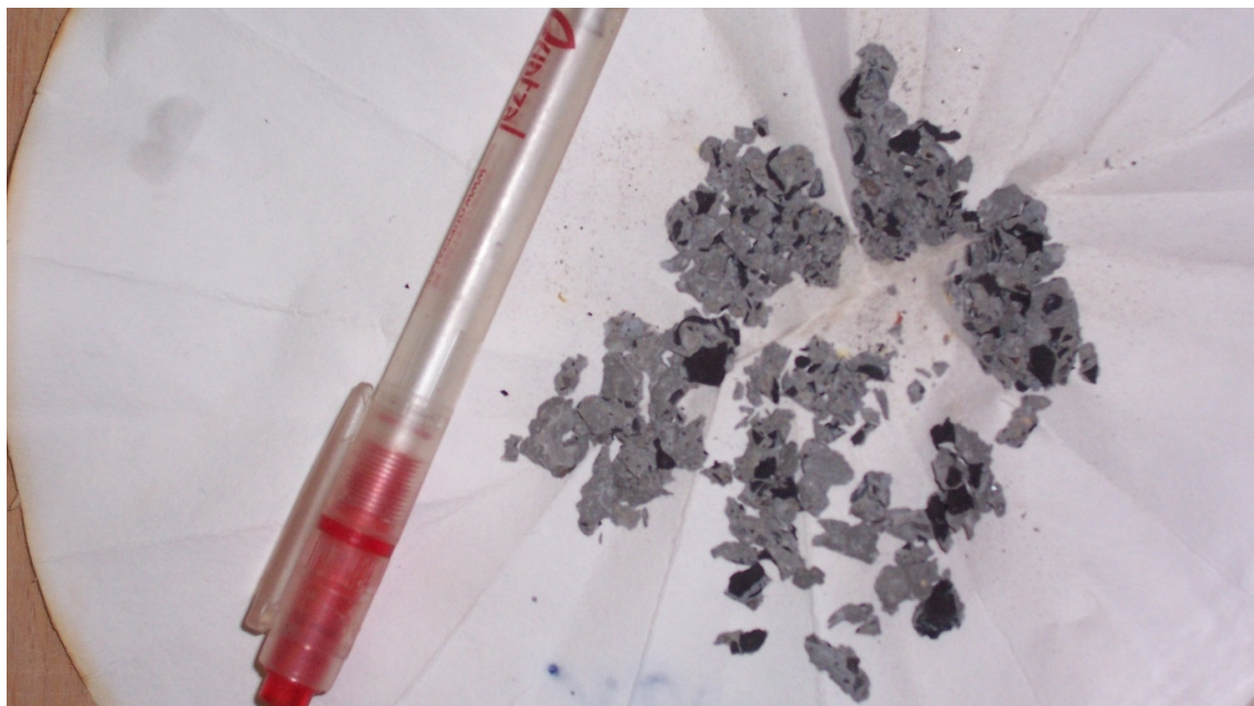
Figuur 3-8: Afgeschilferd materiaal
