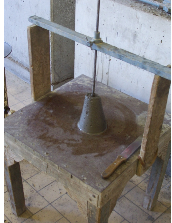
Figuur 3-25: Bepaling slump
