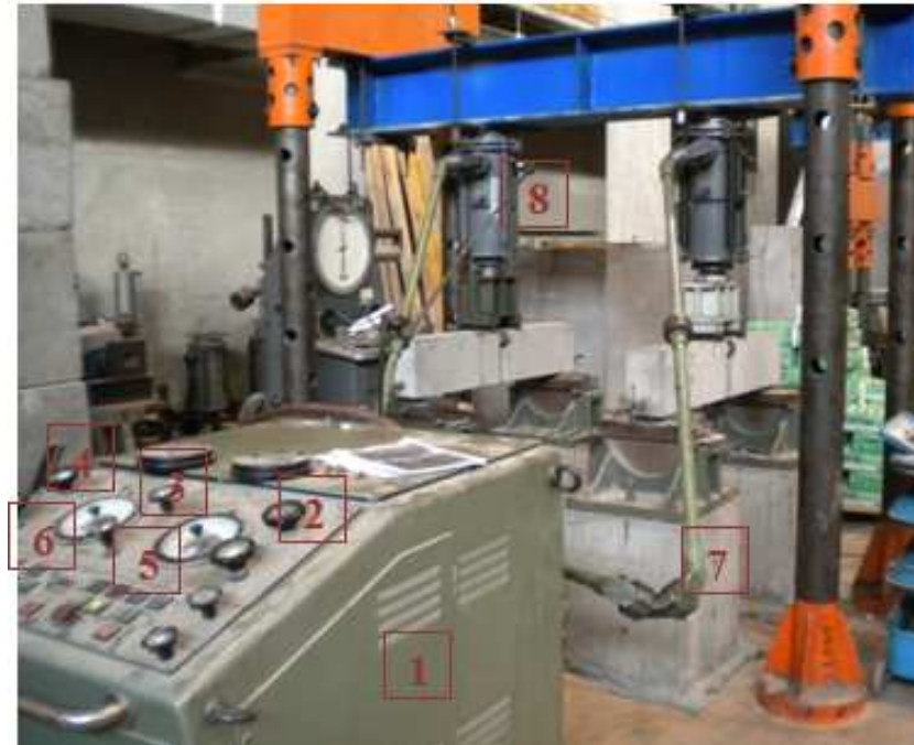
Figuur 53: Werking mechanische pulsator
