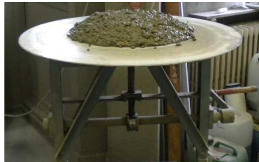
Figuur 22: Voorbeeld opmeten slump en uitvoering van de schoktafel
