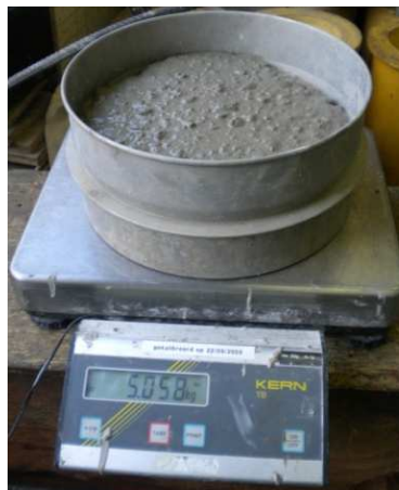
Figuur 15: Illustratie van de sieve segregation test
