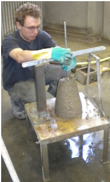
Figuur 22: Voorbeeld opmeten slump en uitvoering van de schoktafel
