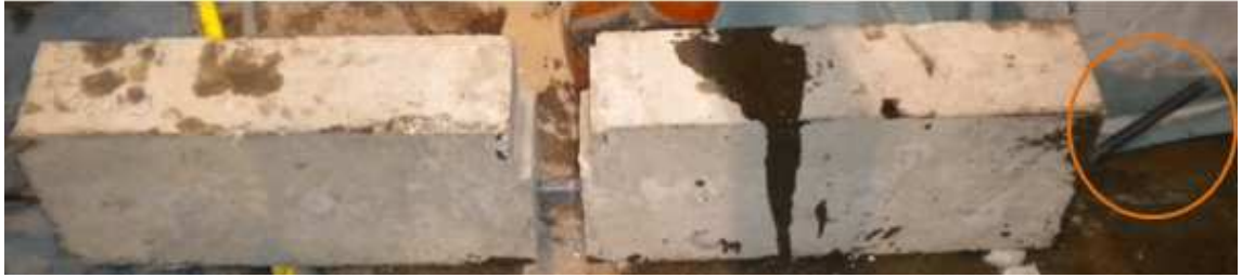
Figuur 41: Beam 0 TB, met geknikte wapeningsstaaf
