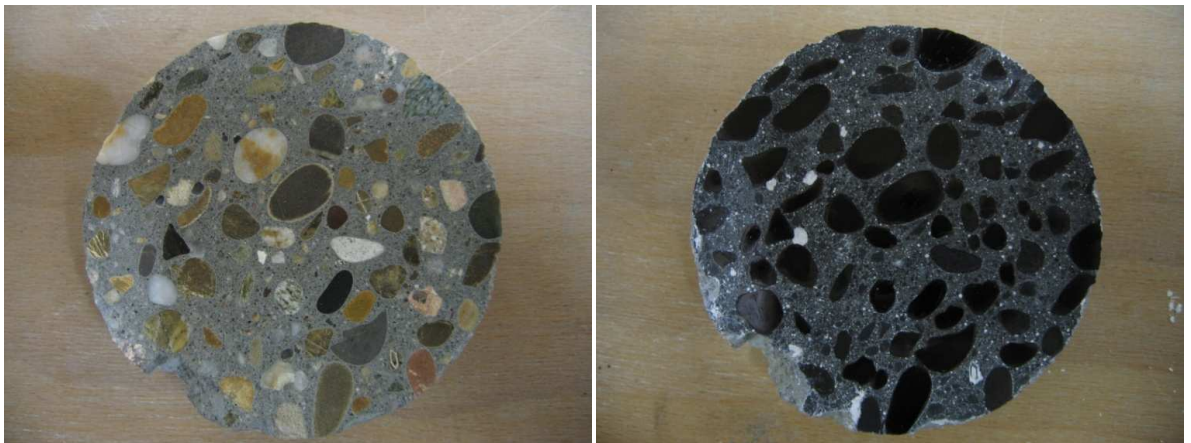
Figuur 17: Voorbereiding gepolijst proefstuk met zwarte inktstift en \text{BaSO}_4 -poeder
