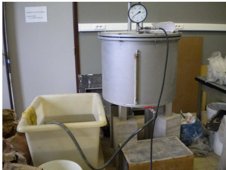
Figuur 5: Proefopstelling vacuümverzadiging: vacuümtank
