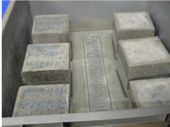
Figuur 6: Proefsopstelling capillariteit
