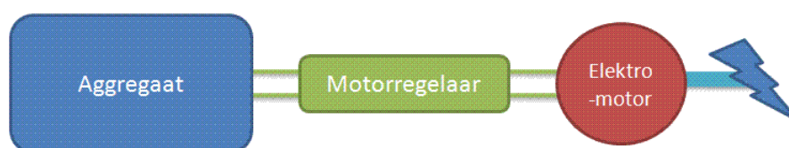
Figuur 19: Schema diesel-elektrische aandrijving
