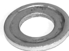
Figuur 2.18 Plastisch vervormde zachte rondel
