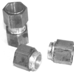
Figuur 6.1 Proefstuk uit aluminium met opgelijmde stalen flanken
