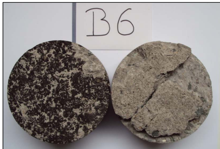
Figuur 57: Afschuifvlak beton / asfalt van boorkern B6
