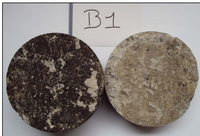
Figuur 55: Afschuifvlak beton / asfalt van boorkern B1
