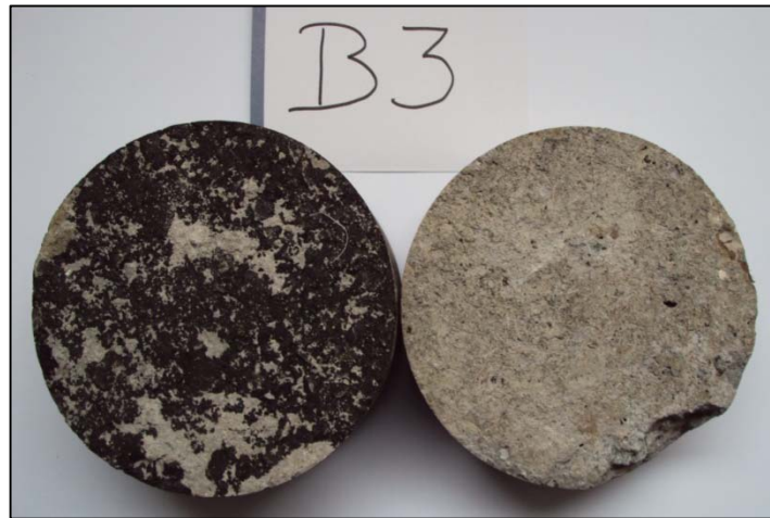
Figuur 56: Afschuifvlak beton / asfalt van boorkern B3
