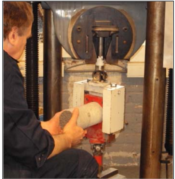
Figuur 54: Apparaat voor de IOWA-afschuifproef
