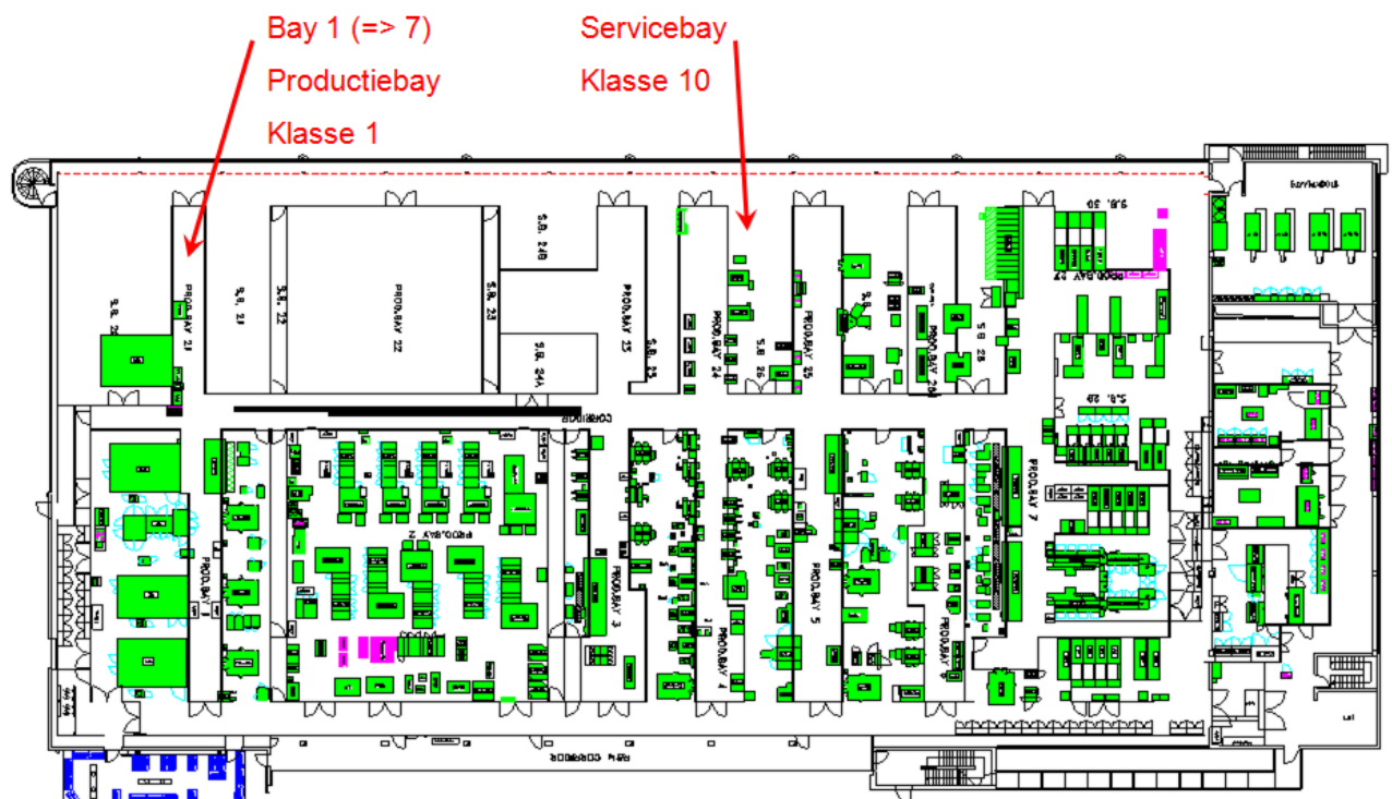
Figuur 3: Grondplan van de FAB met aanduiding productiebay en servicebay
