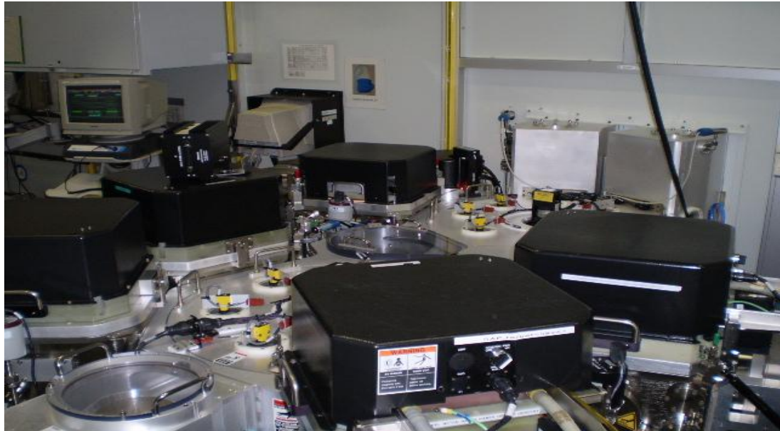
Foto 2: Zicht op het mainframe van een sputter met verschillende kamers (service bay).
