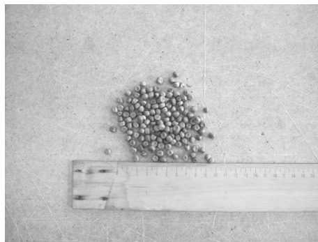
Figuur 5. 18 De gedroogde bonen ( maple peas ) die als afstandshouder worden gebruikt in reeks GB .
