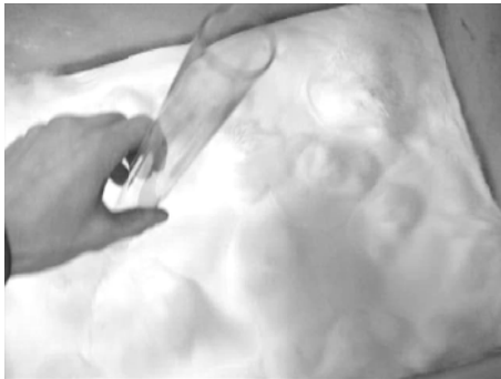
Figuur 5. 8 Verticaal dompelen: het polymeerpoeder bereikt nooit het midden van de glazen buis.
