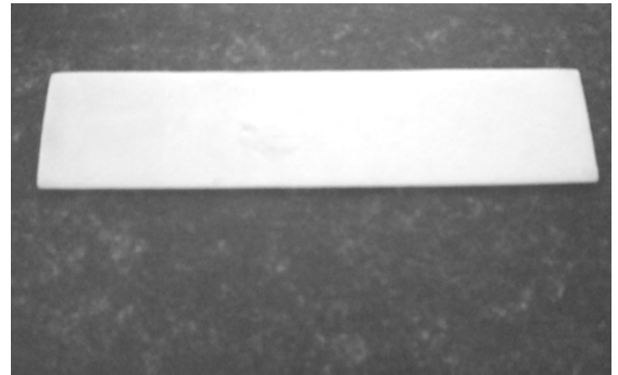
Figuur 3. 7 Glaselement onmiddellijk na onderdompelen in polymeerbak zonder moffelen .
