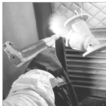
Figuur 2. 3 Het coaten van stalen werkstuk met ES poederspuiten ( Tribo -procedé).
