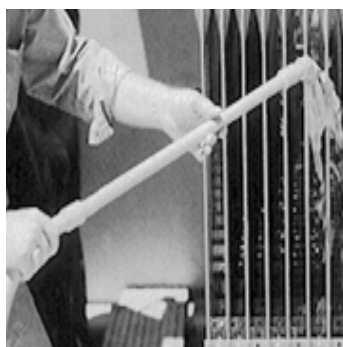
Figuur 2. 9 Het overgieten van elementen met een vloeibare coating . -Bron: www.utilityservice.net -
