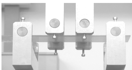
Figuur 4. 11 Proefopstelling vierpuntsbuiging op INSTRON proefbank.
