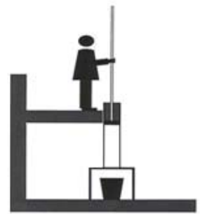
Figuur 1. 17 Specifieke coatingtechniek, ontwikkeld voor het coaten van de binnenkant van glazen buizen.
