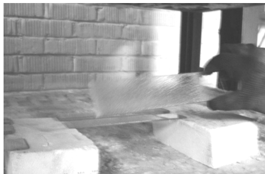
Figuur 3. 8 De op twee stenen rustende proefstukken worden tijdens het bakproces gecontroleerd of ze voldoende lange tijd hebben gemoffeld .
