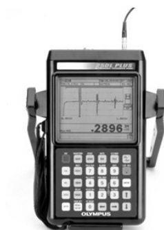
Figuur 5. 10 Ultrasone diktemeter -bron: www.olympus-ims.com -
