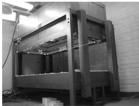
Figuur 3. 5 Stralingsoven ter beschikking gesteld door de faculteit Wetenschappen van de Universiteit Gent.
