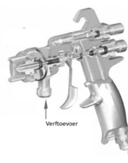
Figuur 2. 12 Opbouw manueel pneumatisch spuitpistool. -Bron:www.bca.eu-
