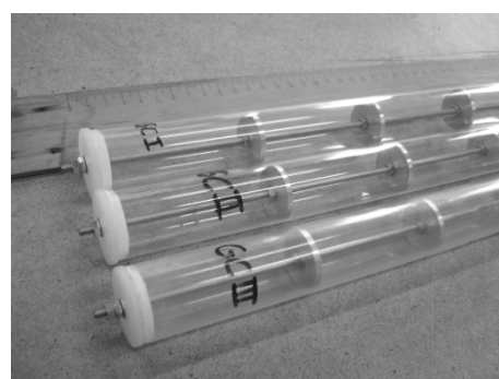
Figuur 5. 17 De drie gerealiseerde kolommen met passende aluminium schijfjes, waarbij GC III werd gecoat aan de buitenzijde.
