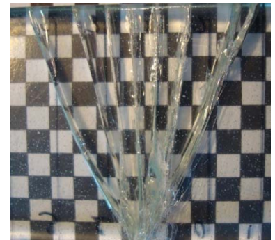
Figuur 4. 8 In de drukzone, t.h.v. breukassen, lokaal losgekomen glasschilfers kleefden in de polymeerlaag.
