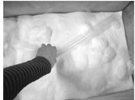
Figuur 5. 9 Horizontaal dompelen: het in suspensie gebracht polymeerpoeder bereikt moeilijk de binnenwand van de glazen buis.
