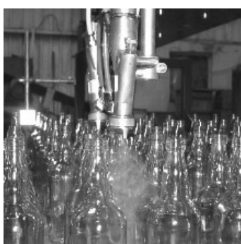
Figuur 2. 11 Het coaten van flessen d.m.v. de spuittechniek (CEC). -Bron:www.glasschem.de-
