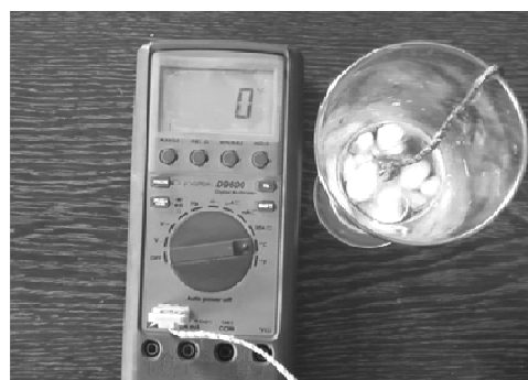
Figuur 3. 17 Ijswater (0°C) als referentiepunt voor ijking van de multimeter.
