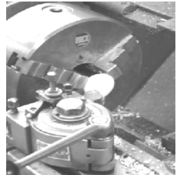
Figuur 5. 14 Op maat vervaardigen van PMMA-dopjes op metaaldraaibank.
