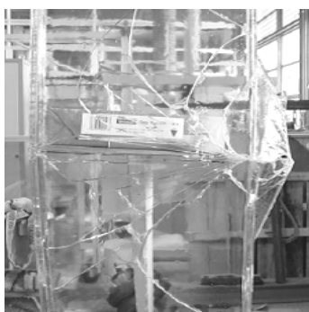
Figuur 1. 14 Breuk van U-profielglas na impact; geen vallende scherven
