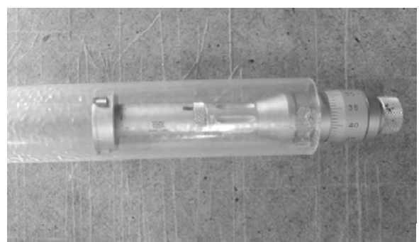
Figuur 5. 11 Met een micrometer werd lokaal de coatingdikte aan het binnenoppervlak van de glazen buis gemeten.
