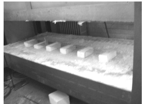
Figuur 3. 4 Elementen rusten op vuurvaste stenen tijdens voorverwarming.
