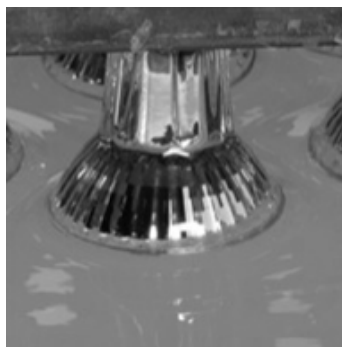
Figuur 2. 7 Onderdompelen van lampen . Bron: www.advancedlampcoatings.com
