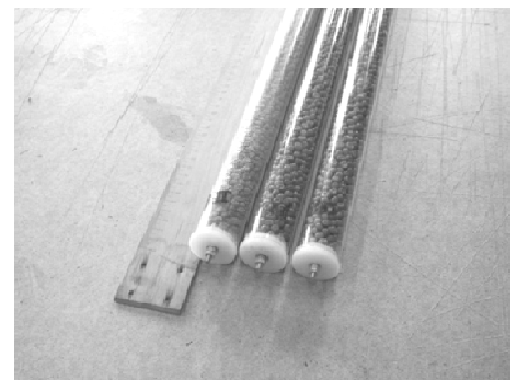
Figuur 5. 19 De drie gerealiseerde kolommen met gedroogde bonen, waarbij GB III werd gecoat aan de binnen- en buitenzijde.
