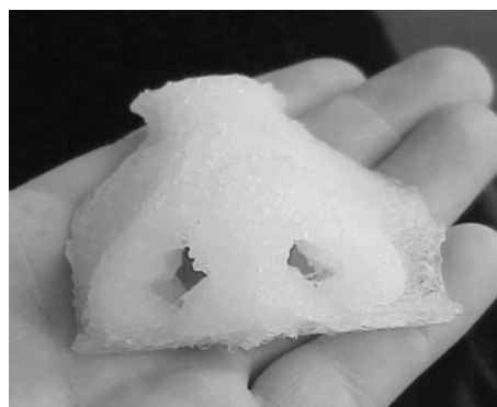
Figuur 3.6: Silicone model van een neus via 3D plotten [38]
