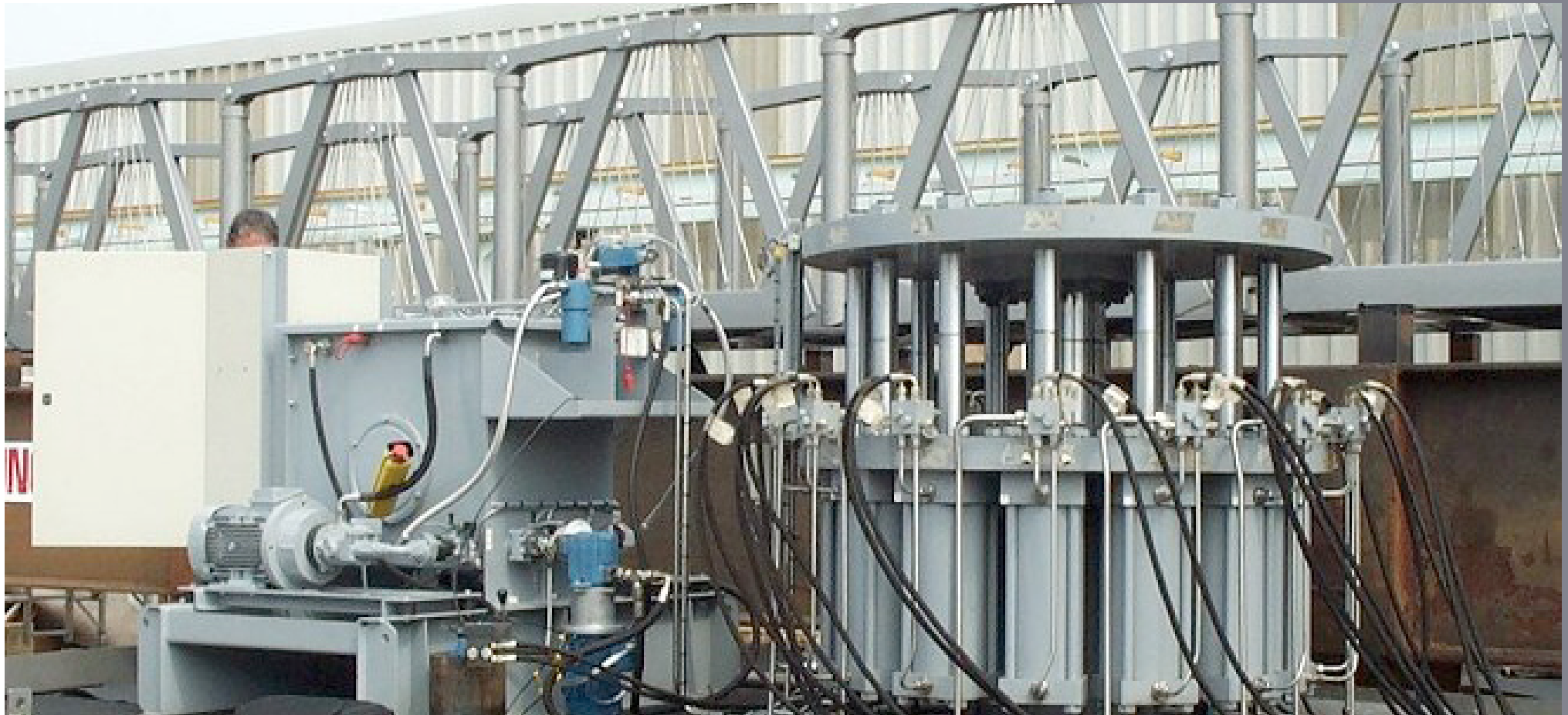
Figuur 3.37_Hydraulisch systeem ( www.selmec.org.uk )
