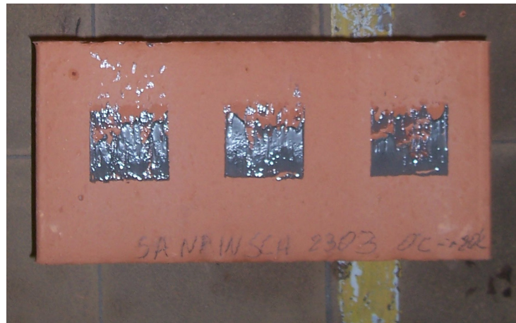
Figuur 31: Gemengd cohesieve-adhesieve breuk bij verwerking van membraan B bij 0°C
