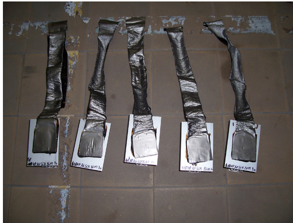
Figuur 33: Op deze samples, die al getest zijn, kan men zien dat het hechtmiddel van membraan A vrij sterk uitloopt
