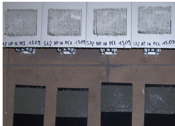
Figuur 30: Gemengde breuk van membraan D op aluminium
