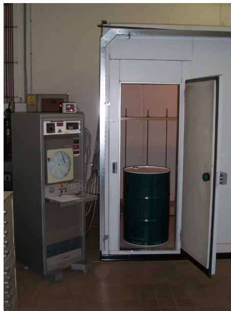
Figuur 26: Klimaatkamer met bijbehorend besturingstoestel
