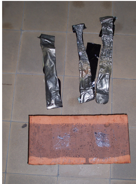
Figuur 35: Baksteen met primer A (aangetast door water aan 60°C) + stroken van membraan A na de trekproef
