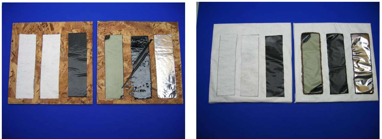
Fig. 12: Foto van de stalen na het testen (de drie meest linkse zijn telkens op basis van butyl; rechtse op basis van bitumen) [13]
