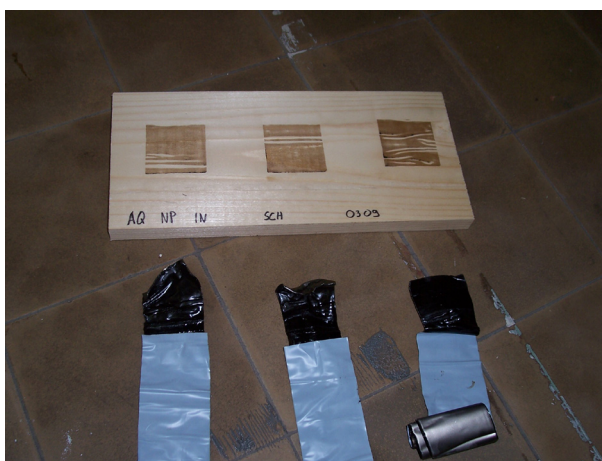
Figuur 27: Vlekvorming van membraan A op geschaafd hout
