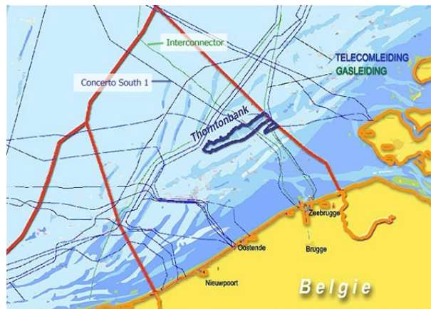
Figuur 2.5: Gasleidingen en bekabeling op het BCP [C-Power, 2009].
