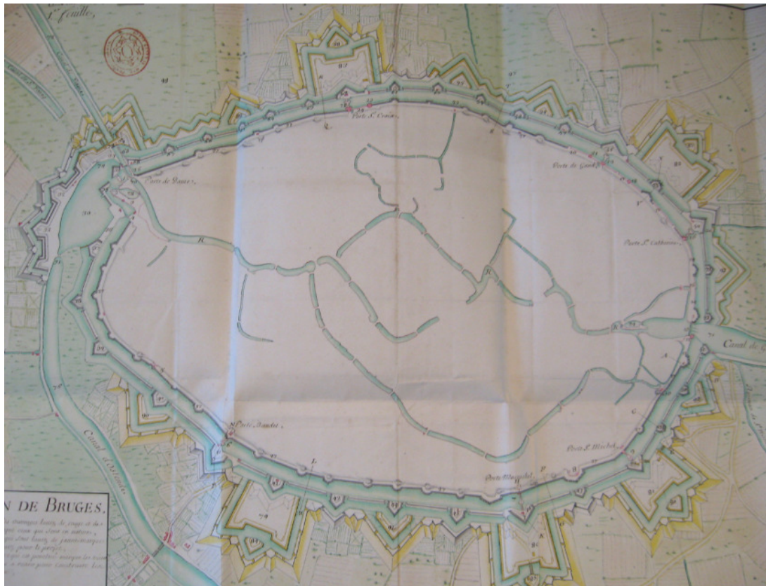
Figuur 5 Plan voor de verbeteringswerken aan de Brugse versterkingen (Vauban, 1701) 47
