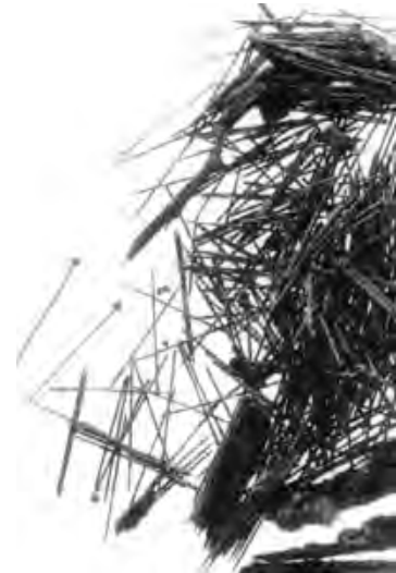
Afb. 72 Kluit halffabriek spelden (de meeste moesten nog een kopje krijgen) met datering XIVd-XVB (Clevis & Smit: 1990, p. 115)
