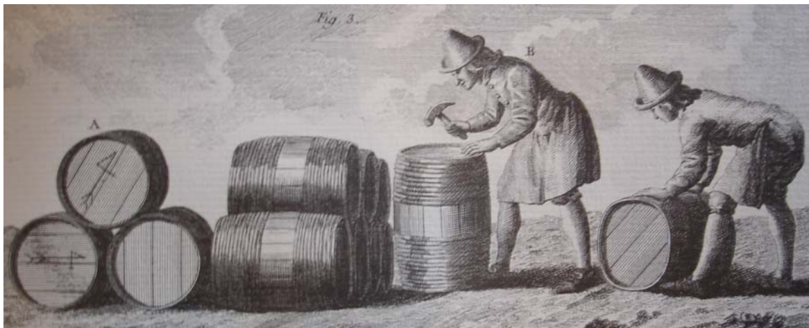
Afbeelding 21. Het luchtledig slaan van vistonnen. Gravure uit H. Duhamel du Monceau, Traité général des pêches (Parijs, 1769)
