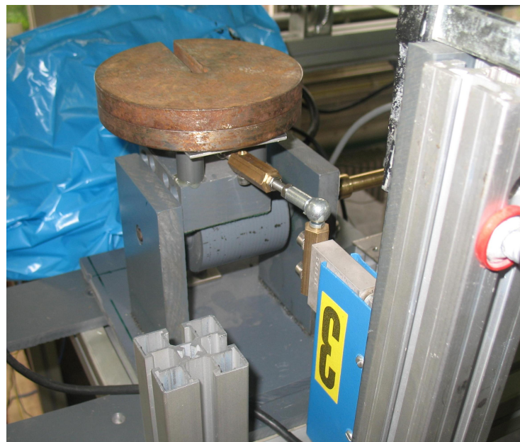
Figuur 5.11: Het pvcstukje glijdt tegen de verticale plaat waardoor extra wrijving ontstaat
