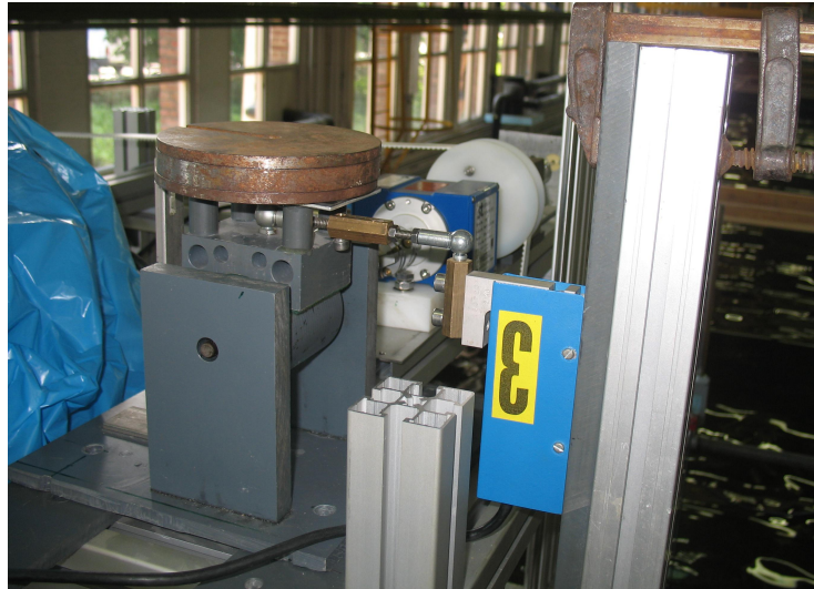
Figuur 5.9: Detail van de krachtsensor (blauw met omgekeerd cijfer 3 erop)
