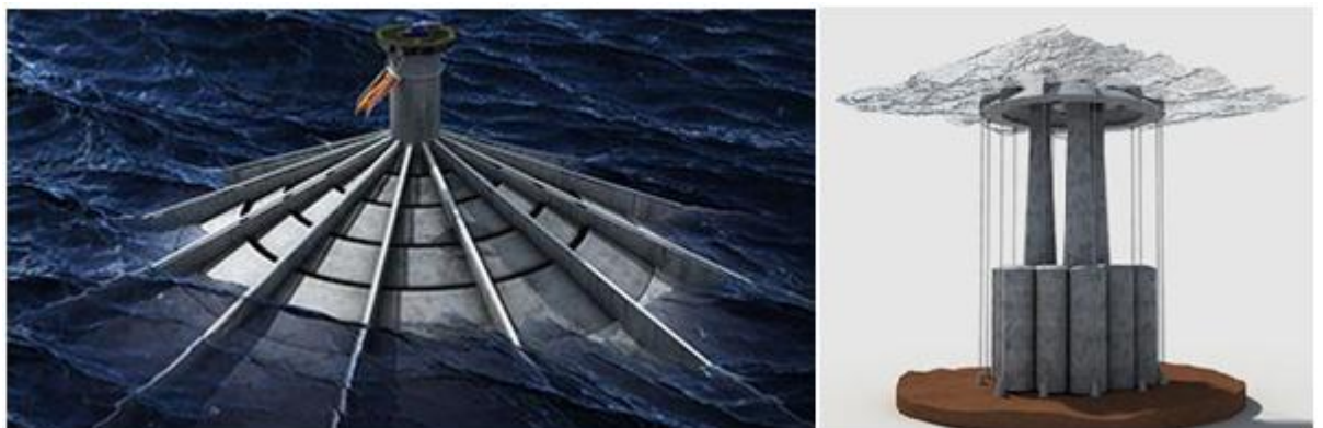
Figuur II-11: Installatie van de SSG offshore (vaststaand type) [20]
