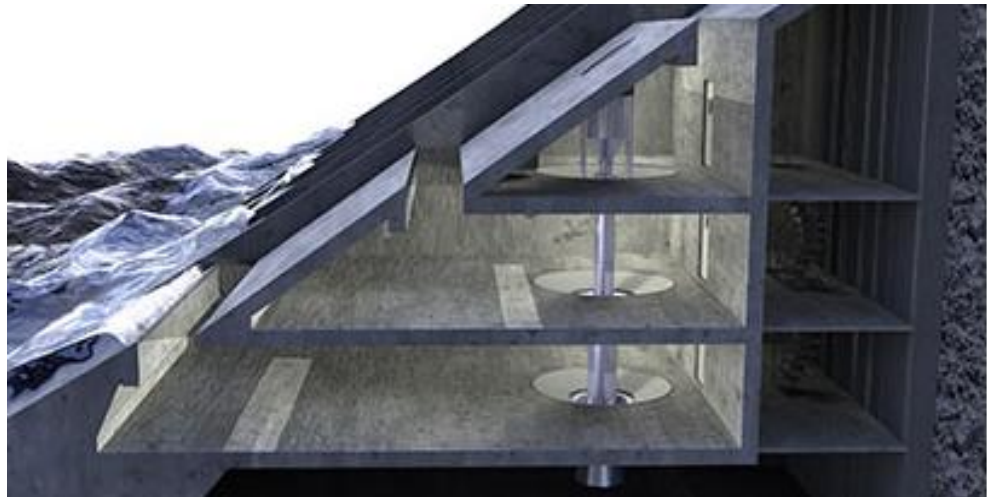
Figuur II-8: De meertrapsturbine van de SSG [20]
