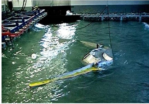
Figuur II-16: Schaalmodel 1:50 te Aalborg [33]
