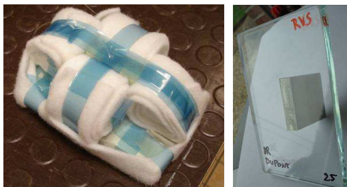
Figuur 3.14: proefstuk RVS_glad_T_25 verpakt (links) en na laminatie (rechts).
