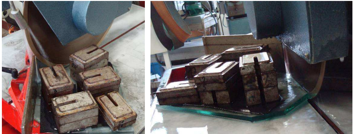
Figuur 5.6: zagen van de uitsparingen met behulp van een watergekoelde cirkelzaagmachine.
