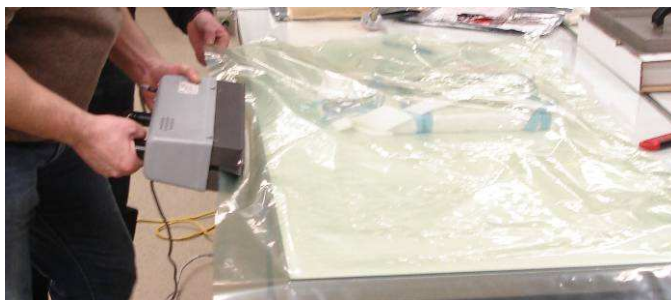
Figuur 4.30: dichtsmelten van de vacuüm bag.
