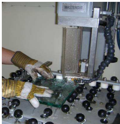
Figuur 4.22: zagen van een uitsparing in de middelste glasplaat met een watergekoelde lintzaagmachine.
