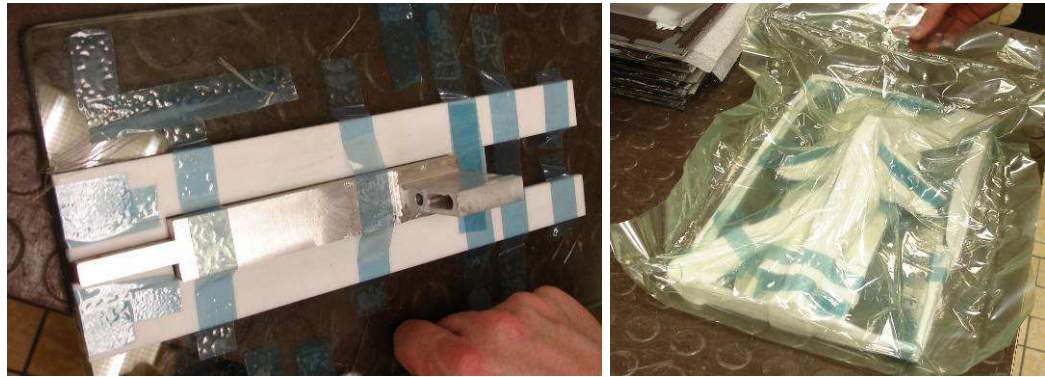
Figuur 4.28: prototype T3_03_H1: teflon mal met kleefband bevestigd (links) en vacuüm verpakt element (rechts).
