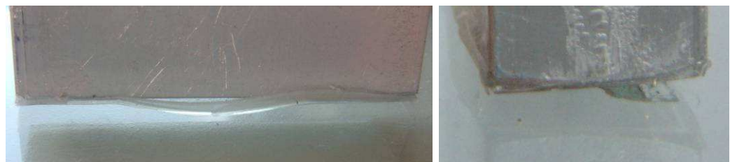
Figuur 3.37: kanteling om de zwakke as bij proefstuk alu_vijl_T_29, zijaanzicht (links) en vooraanzicht (rechts).
