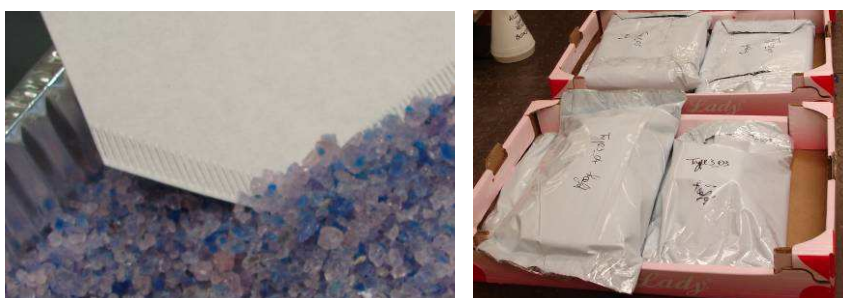
Figuur 5.12: vochtabsorberende silica korrels (links) en verpakte proefstukken (rechts).
