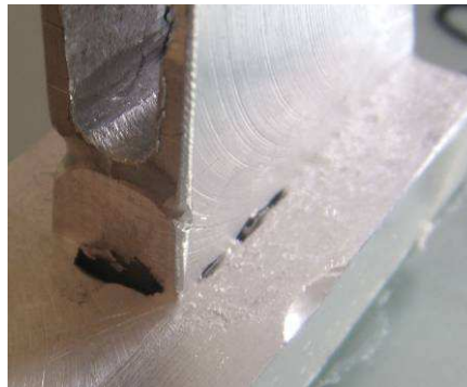
Figuur 5.5: onvoldoende inbranding van de las bij prototype T2_04_H.
