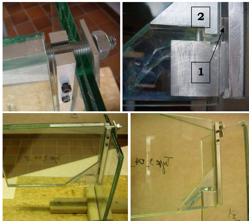
Figuur 5.28: Ontwerp T3_04 (1: stelblokje, 2: verzonken inbusbout).
