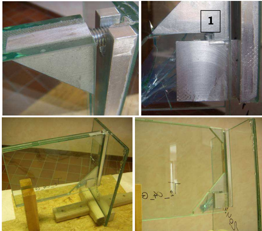
Figuur 5.24: Ontwerp T2_04, versie 2 (1: verzonken inbusbout).
