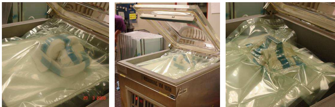
Figuur 3.12: open vacuüm bag (links), vacuümtoestel (midden) en vacuüm verpakt proefstuk (rechts).
