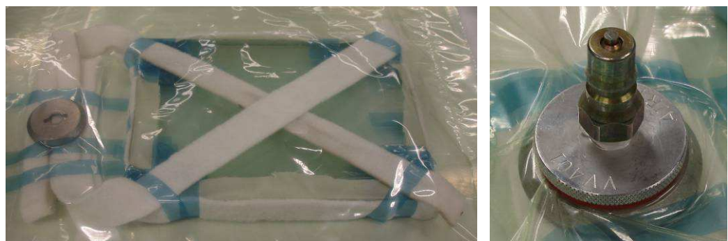
Figuur 4.29: luchtkanalen rond prototype T2_01_G1 (links) en ventiel met dichtingsring (rechts).
