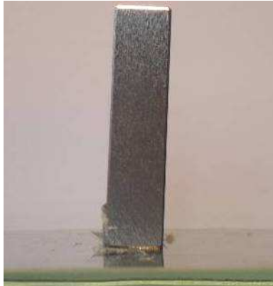
Figuur 3.23: scheefstand proefstuk RVS_glad_T_24.
