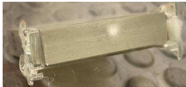
Figuur 3.25: vloeï bij proefstuk RVS_glad_M_9.
