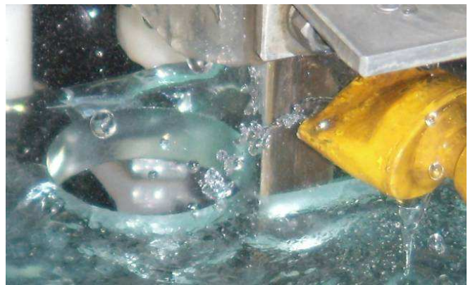
Figuur 4.22: zagen van een uitsparing in de middelste glasplaat met een watergekoelde lintzaagmachine.
