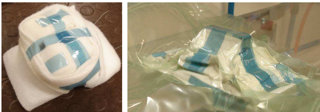
Figuur 3.19: verpakt proefstuk voor (links) en na (rechts) het vacuüm zuigen.
