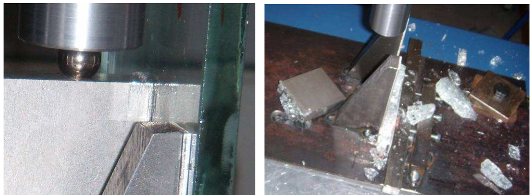
Figuur 3.31: stalen kogel (links) en vroegtijdig bezwijken van het glas bij versie 1 van de proefopstelling, let op het metaalelement waarbij geen onthechting optrad (rechts).
