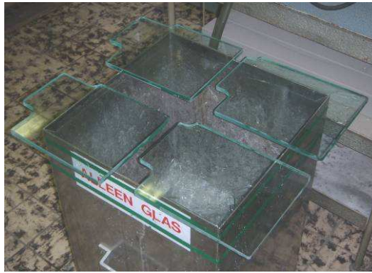
Figuur 4.23: resulterende middelste glasplaten van de prototypen van de gordingen.
