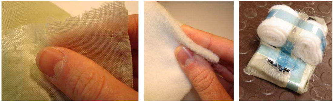
Figuur 3.11: zijde (links), isolatiedeken (midden) en ingepakt proefstuk (rechts).
