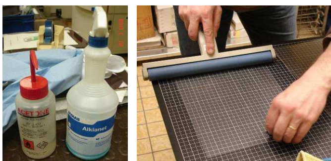
Figuur 3.10: reiniging van de verschillende onderdelen, rechts de Dust Cleaning Roller.
