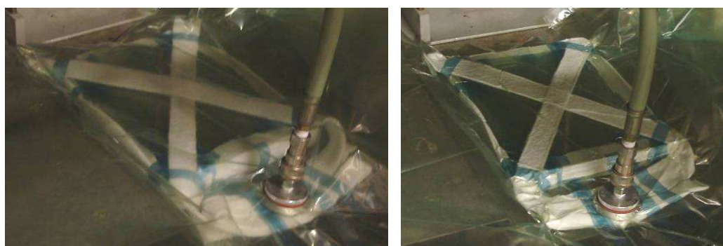
Figuur 4.31: permanent vacuüm zuigen van prototype T2_01_G1 in de autoclaaf: vastkoppelen van de luchtslang (links) en vacuüm zuigen (rechts).
