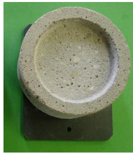
Figuur 2.11: Proefstuk uitgeboord tot op een diepte van 10 mm
