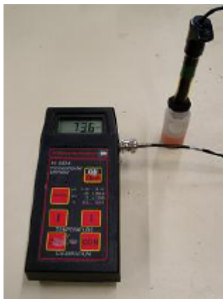
Figuur 2.13: Voltmeter en elektrode gebruikt om de chloridenconcentratie op te meten
