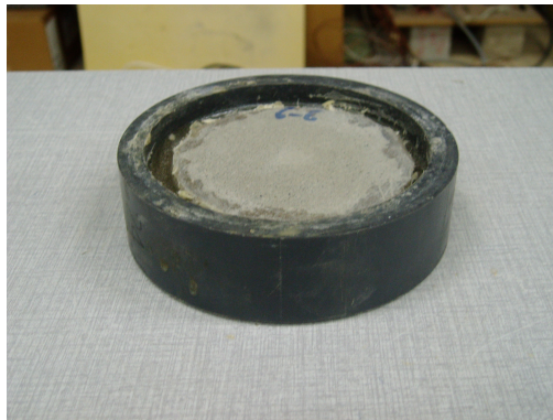
Figuur 2.6: Proefstuk met behulp van epoxyhars ingekleefd in een PVC-ring
