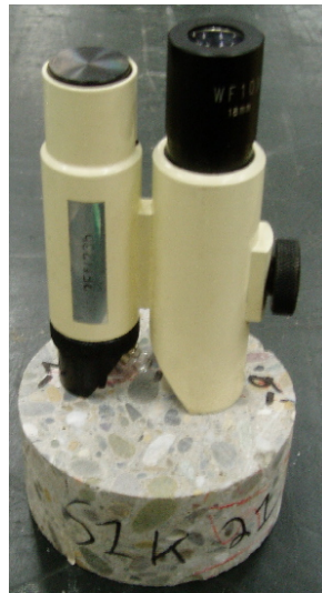
Figuur 2.2: Gebruik van de scheurmicroscoop om de scheurbreedte van de niet gestandaardiseerde scheur op te meten
