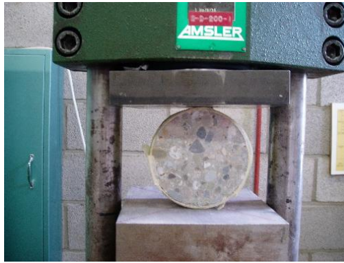
Figuur 2.1: Splijtproef op een cilinder uit beton om een niet-gestandaardiseerde scheur te verkrijgen
