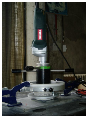
Figuur 2.10: Inklemming van het proefstuk in de Profile Grinder PF-1000
