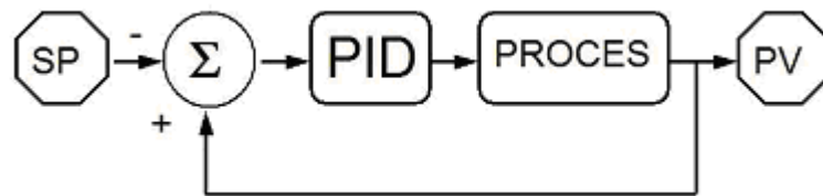
Figuur 5.1: Schematisch overzicht PID regeling.
