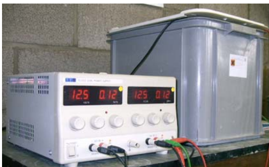
Figuur 4.2: proefopstelling CTH test, aangewend voltage = 25 V (foto genomen door auteur)
