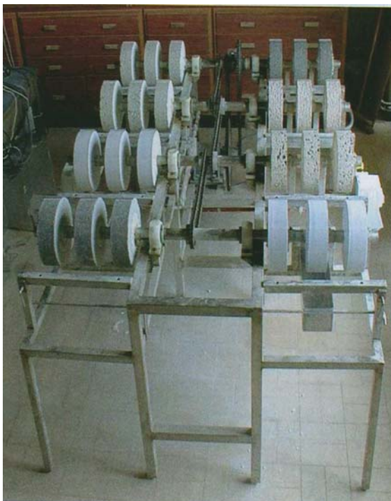
Figuur 2.9: proefopstelling voor de cyclische onderdompeling [94]
