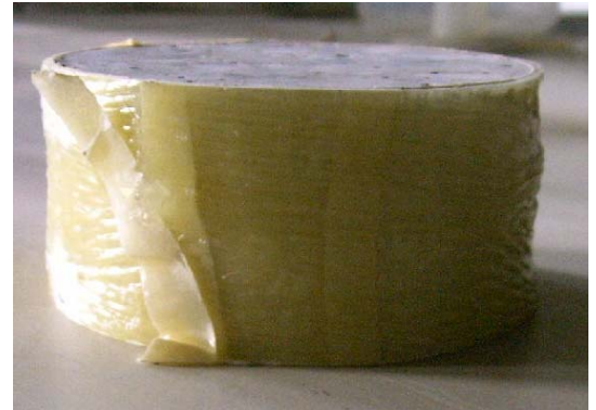
Figuur 4.1: FRP - wapening rond de proefstukken (foto genomen door auteur)
