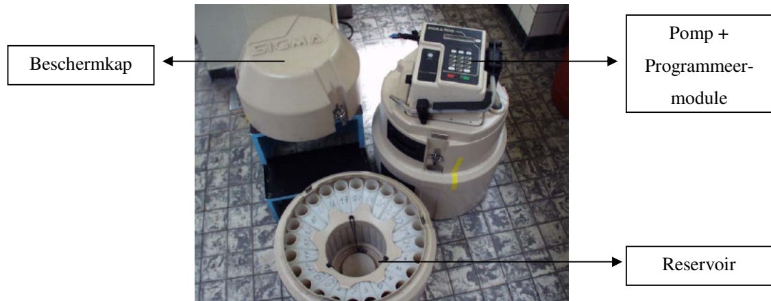
Figuur 3.5: Sampler, beschermkap en reservoir van de door het WL gebruikte pompsampler
