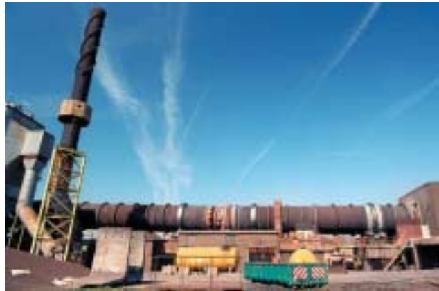
Figuur 6.2 – Argex wordt vervaardigd in een draaioven bij 1100 °C
