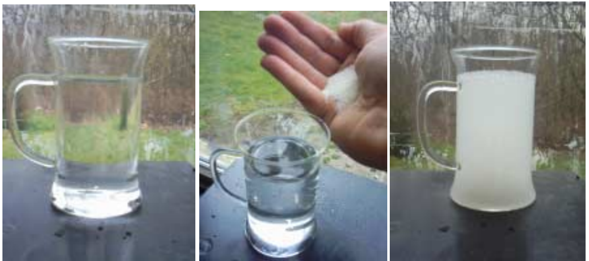
Figuur 7.1 – Een illustratie van het absorberend vermogen van SAP-korrels links: glas water / midden: bijgevoegde SAP-korrels / rechts: SAP na gelvorming
