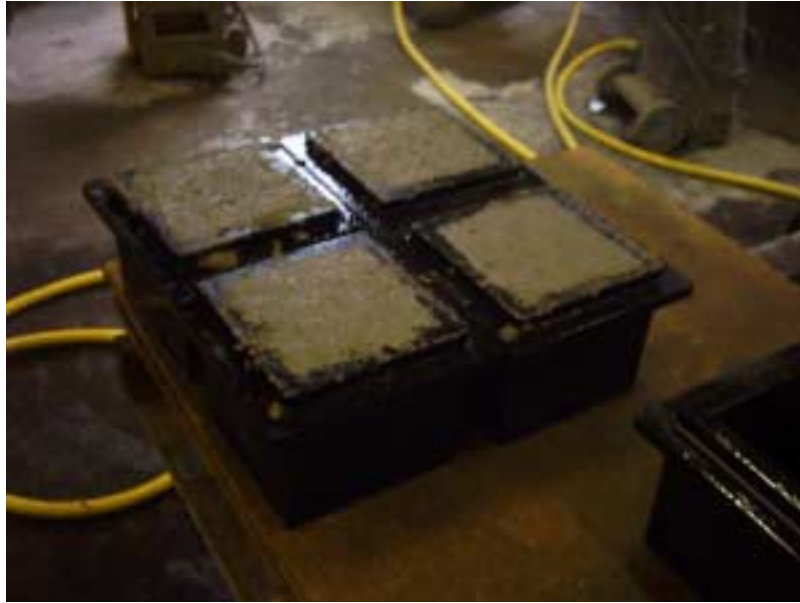
Figuur 5.8 – 4 kubussen ter bepaling van de druksterkte op 1, 7 en 28 dagen
