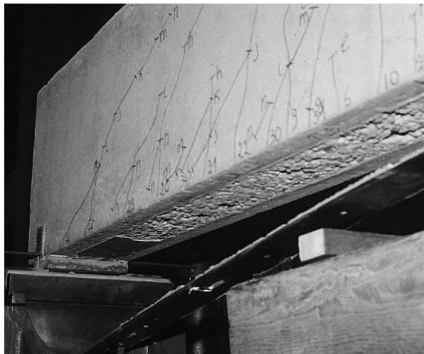
Fig. S-8 Typisch bezwijkaspect van de versterkte balken door onthechting
