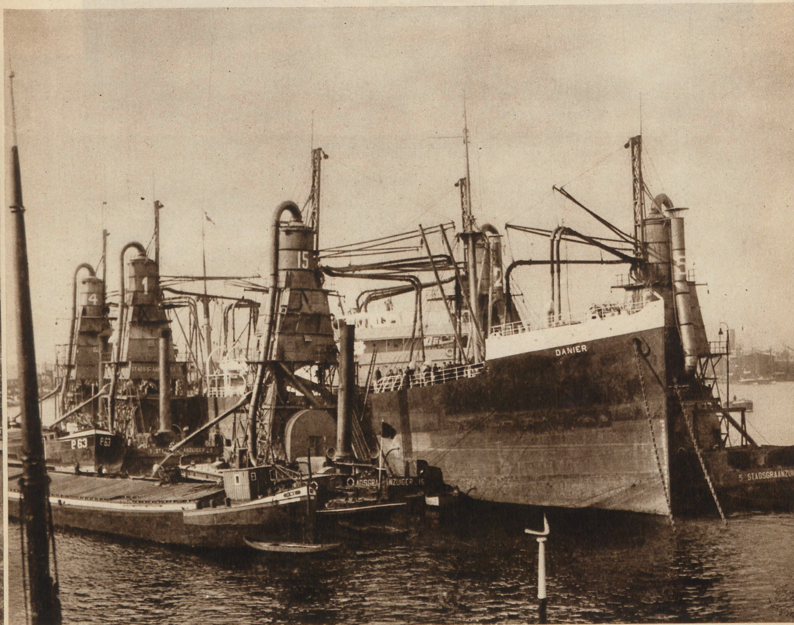
ELEVATEURS A GRAINS DECHARGEANT UN NAVIRE EN ALLEGES A RAISON DE 180 TONNES PAR ELEVATEUR ET PAR HEURE. (PHOTO FERD. CLAES.)
