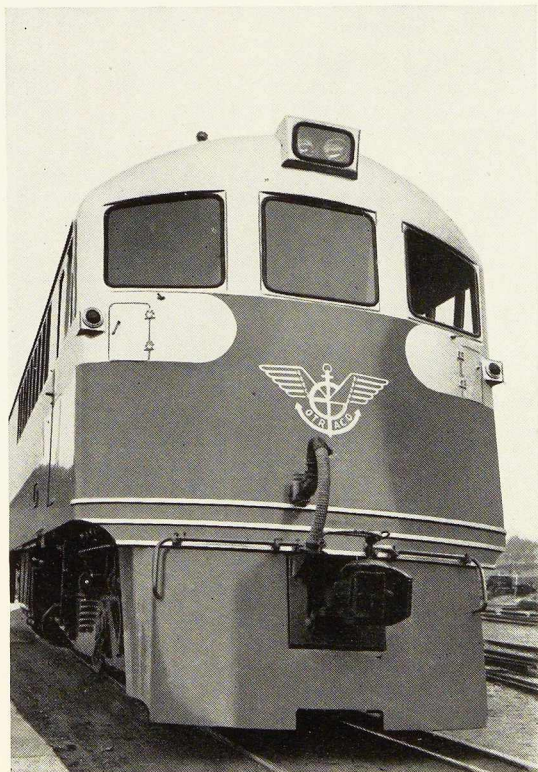
Locomotive Diesel électrique 1 500 CV/91 t à commande à unité simple ou double.
