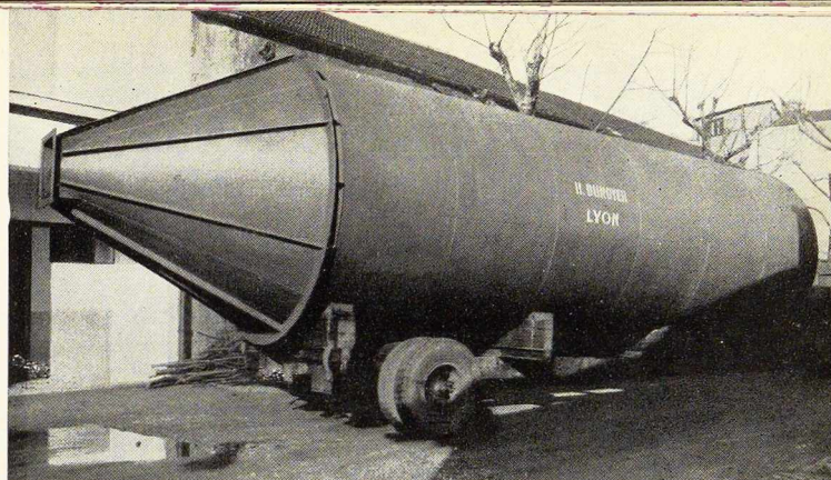
Fig. 24. Réservoir soudé de 35 m 3 . (Constructeur : H. Dunoyer.)
