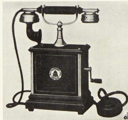
FIG. 2. APPAREIL TÉLÉPHONIQUE. Bell Telephone, Anvers, 1910. Le principe de la téléphonie n'a pas encore trouvé l'appareil commode et confortable, présent et discret, satisfaisant à la fois l'œil et la main. Réception et émission fonctionnent d'une manière indépendante. Boîte, béquille, cornet. Correcte solution technique, conception hostile.
