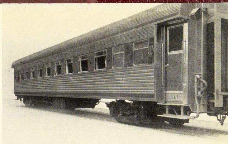
Fig. 8. Voiture en acier inoxydable, exécutée sous licence de la Budd Company par la Brugeoise et Nicaise & Delcuve. Photo R. Bauters.
