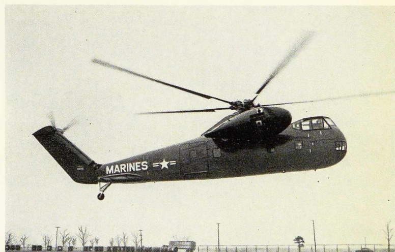
Fig. 16. Hélicoptère type standard Sikorsky S-55 de 600 CV, en service sur la ligne Bonn-Cologne et Liège-Bruxelles (vitesse 140 km/h).
