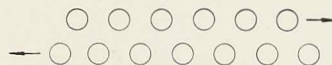
Fig. 2. Représentation classique du glissement relatif entre deux plans réticulaires sollicités par cisaillement.
