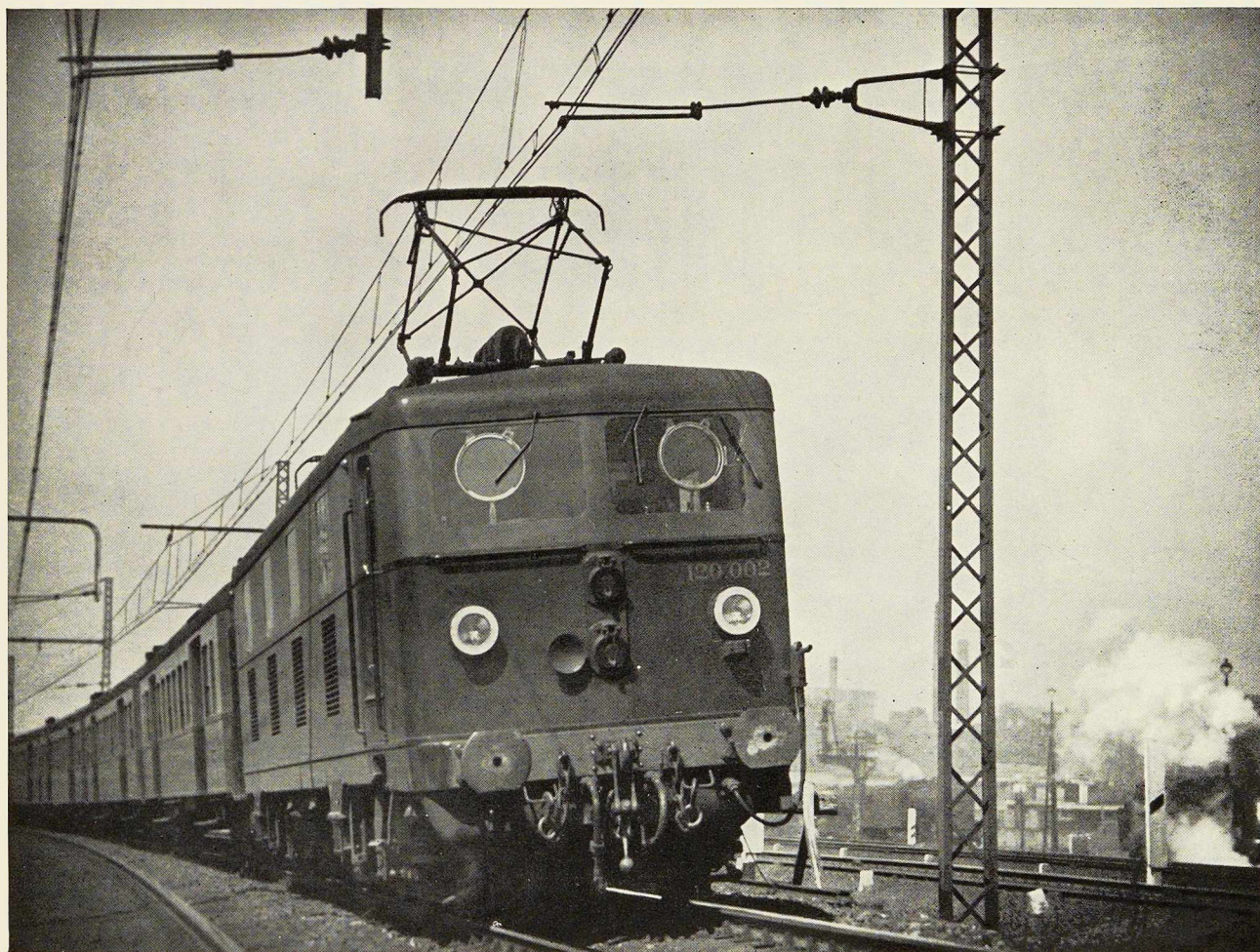
Locomotive électrique Bo-Bo, 125 km/h, fournie à la S. N. C. B.
