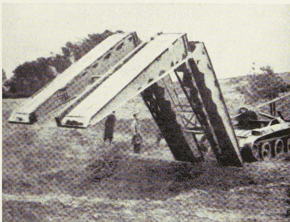
Fig. 6. Char-pont « Ciseaux ». Phase de lancement du pont.
