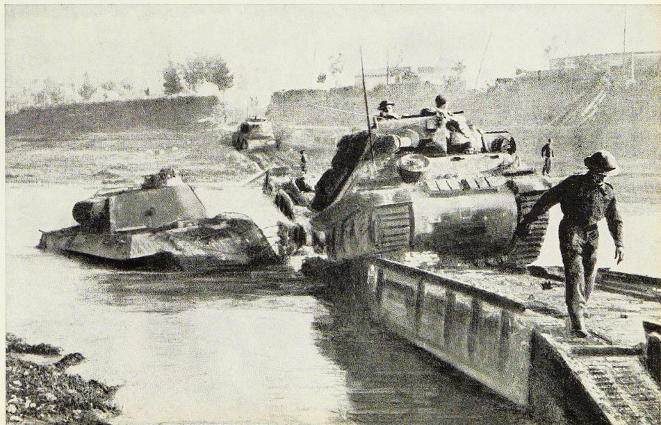
Fig. 4. Un cas d'emploi de plusieurs « Ark » en tandem, dans une rivière peu profonde.
