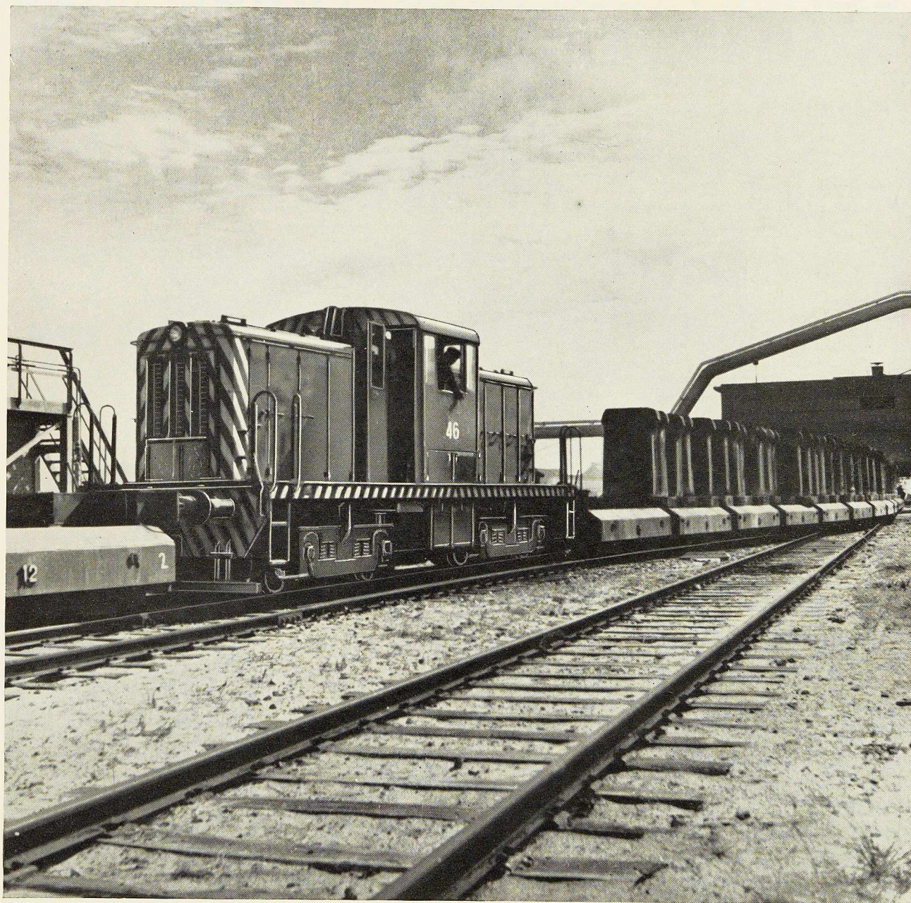
Locomotive Diesel électrique 50 tonnes
