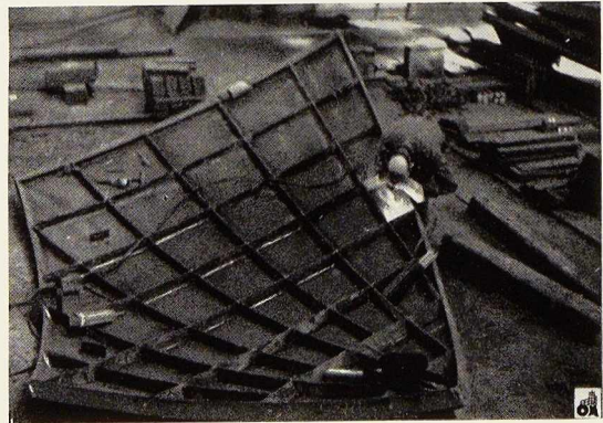
Fig. 3. Eléments de diffuseur pour centrale hydro-électrique réalisés en construction soudée.
