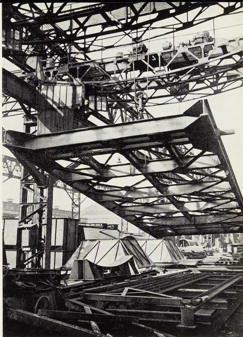
Fig. 6. Châssis-palette quittant l'atelier de chaudronnerie.
