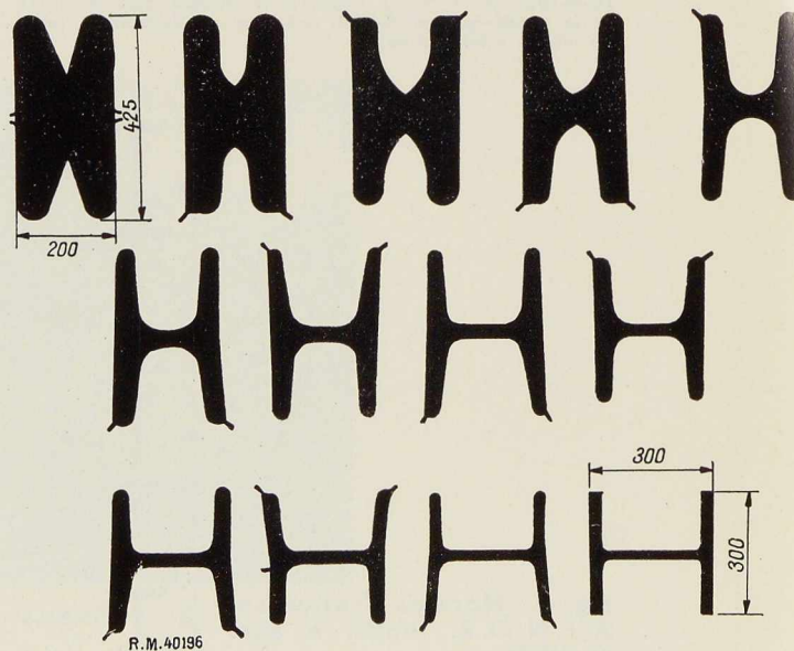
Fig. 2. Méthode de laminage à canelures emboîtées.
