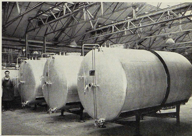
Fig. 2. Série de réservoirs à pression en acier inoxydable, d'une contenance de 9.000 litres.
