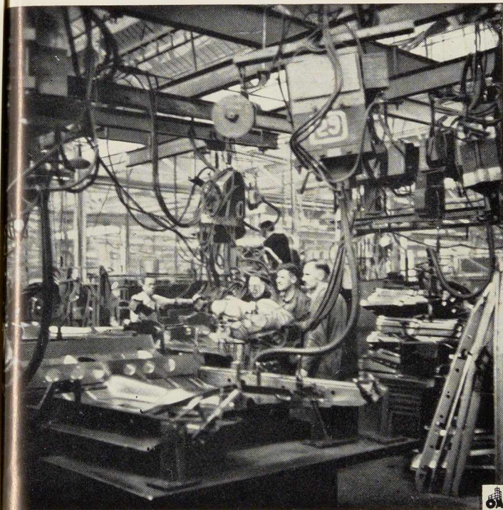
Fig. 3. Un des nombreux postes à souder employés à la « Pressed Steel Co. Ltd », pour la fabrication des pièces en acier embouti pour carrosseries d'autos.
