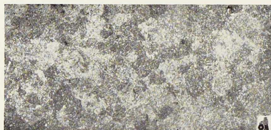
Fig. 505 (en haut, à droite). Texture sorbitique. (Grossissement \times 100 .)
