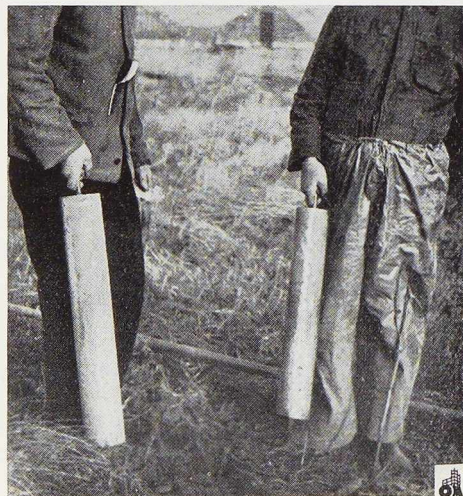
Fig. 781. Electrodes en magnésium, pour protection cathodique de conduites souterraines.
