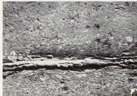
Fig. 773. Corrosion d'un joint soudé à l'extérieur de la carène d'un navire de mer.
