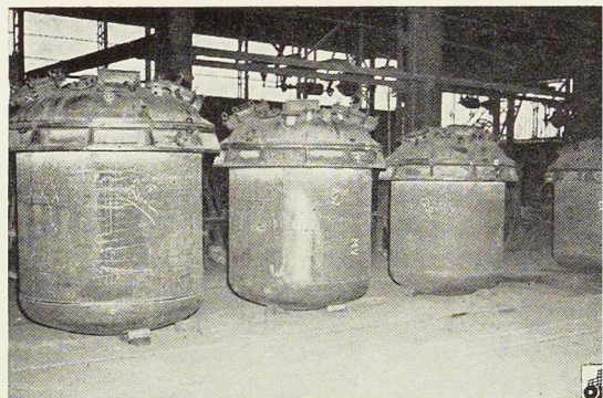
Fig. 610. Série de cuves de 5 000, 4 000 et 3 000 litres terminées.
