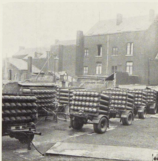
Fig. 279. Bonbonnes d'oxygène servant aux essais de suroxygénation de l'air, à Ougrée.
