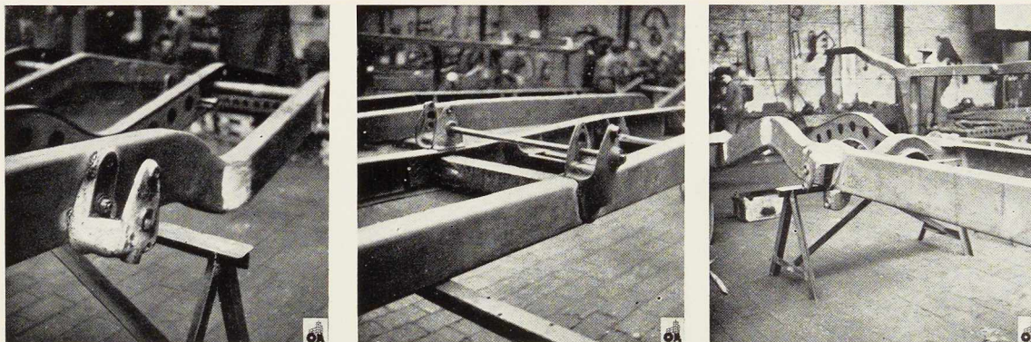
Fig. 230-232. Détail de la soudure des mains de ressort en acier coulé sur le châssis. — Autre assemblage soudé d'un support en acier coulé sur la membrure principale. — Vue de la partie centrale du châssis soudé.
